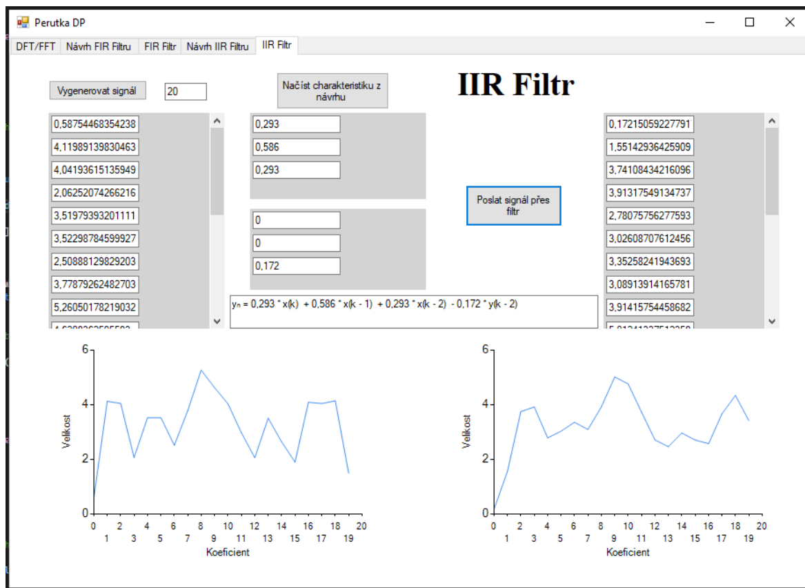
Obrázek 43: Příklad IIR filtrace
