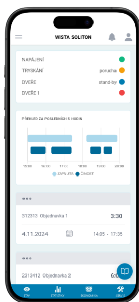
Obrázek 12: Návrh úvodní obrazovky (Status stroje)
