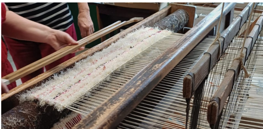
Zachycení fáze ručního prohazování člunku osnovou během tkaní hadrového koberce.
