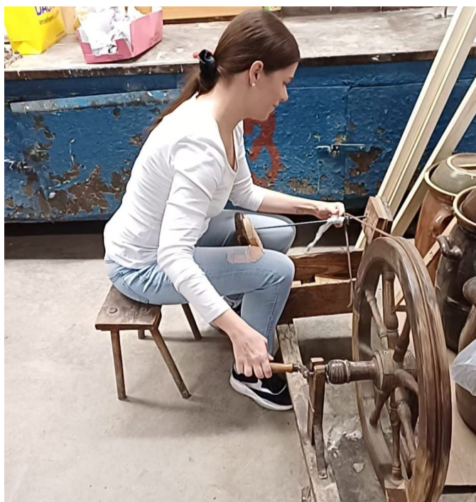
Obrázek 22 Navíjení látkových proužků na cívku pomocí špulíře
