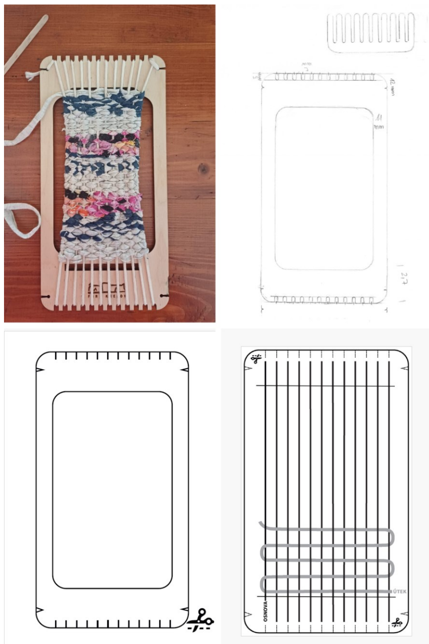
Obrázek 25 Vývoj rámu pro tkaní – testovací destička, ruční návrh, první digitalizovaná verze a druhá digitalizovaná verze s úpravou velikosti
