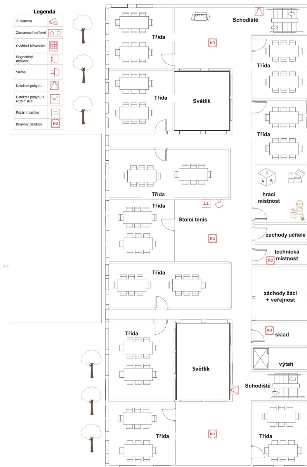
Obrázek 26 Druhé patro hlavní budovy s elektronickými zabezpečovacími systémy
