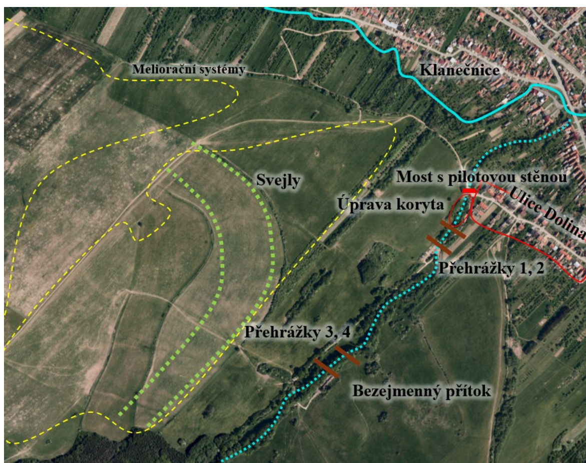
Obrázek 85 – Návrh zasakovacích příkopů pro oblast č. 4 [vlastní]
