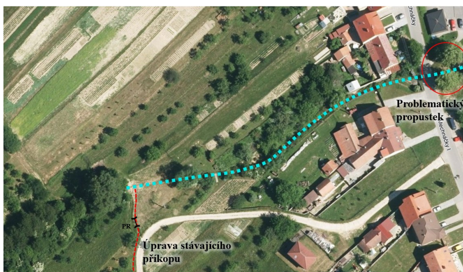
Obrázek 67 – Úprava koryta toku pravostranného přítoku [vlastní]
