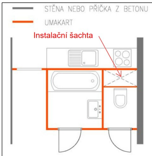
Obrázek 6 Příklad umístění bytového jádra v panelovém domě
