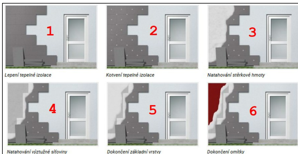
Obrázek 34 Zateplovací systém ETICS
