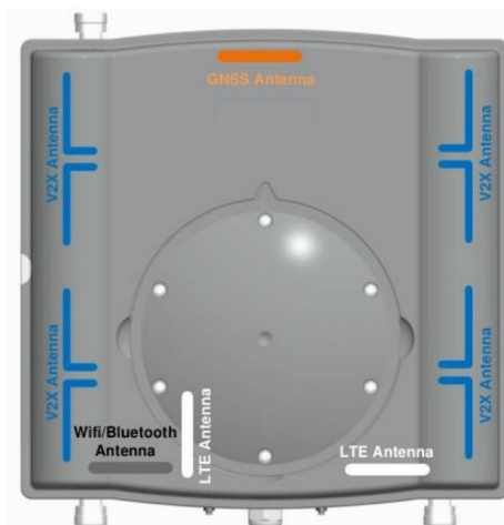
Obrázek 22 Pozice interních antén RSU 2X Yunex Traffic
