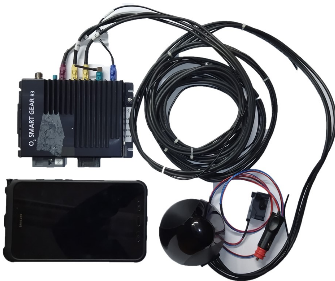
Obrázek 46 OBU Smart Gear R3 s kombinovanou anténou a tabletem
