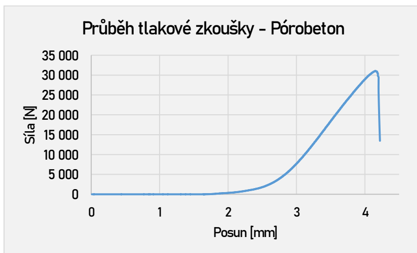
Obrázek 7 Graf průběhu tlakové zkoušky
