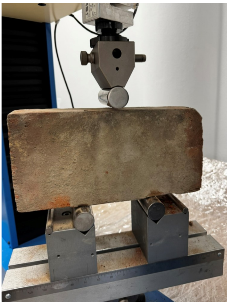
Obrázek 10 Zkouška pevnosti v ohybu
