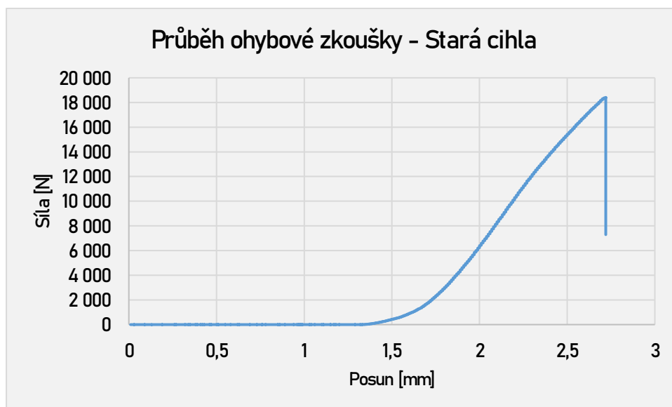
Obrázek 9 Graf průběhu ohybové zkoušky
