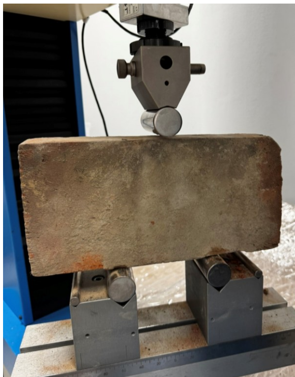
Obrázek 22 Zkouška ohybem – Nová pálená cihla
