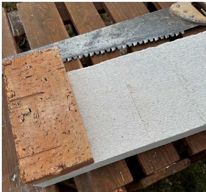
Obrázek 15 Zkušební vzorky Ytongu a pálené cihly ve stejných rozměrech
