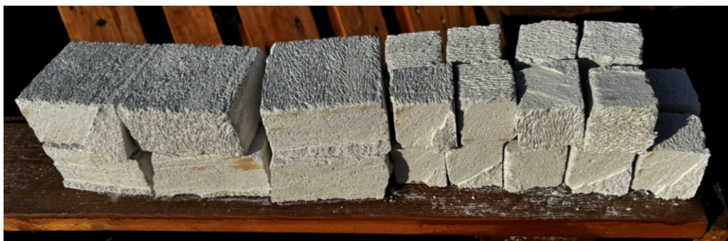
Obrázek 13 Zkušební vzorky ve velikostech 5×5 cm a 10×10 cm
