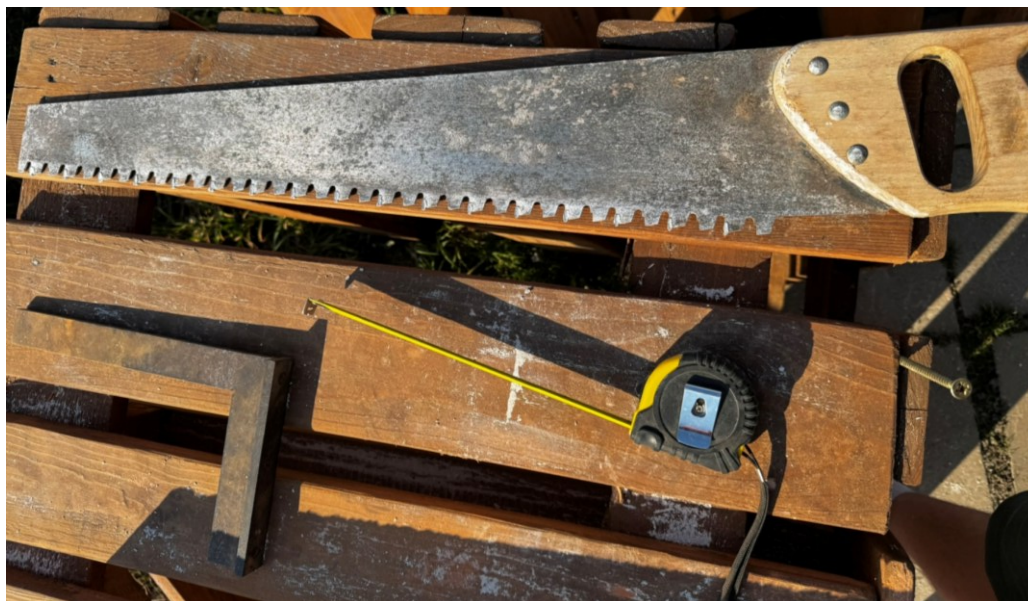
Obrázek 17 Použité nástroje pro úpravu velikosti Ytongu
