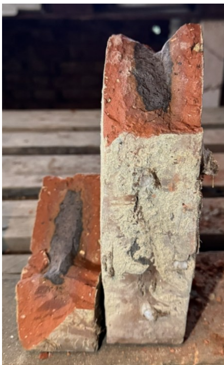
Obrázek 25 Výsledné rozlomení staré pálené cihly
