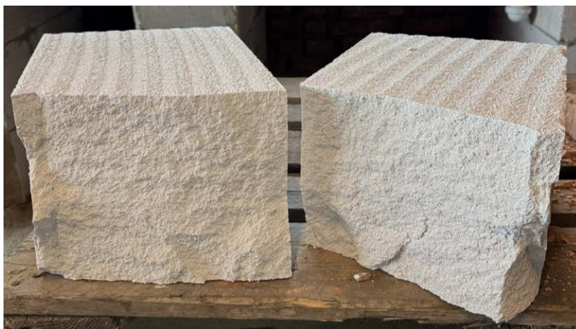
Obrázek 28 Výsledné rozlomení pórobetonu (Ytongu)
