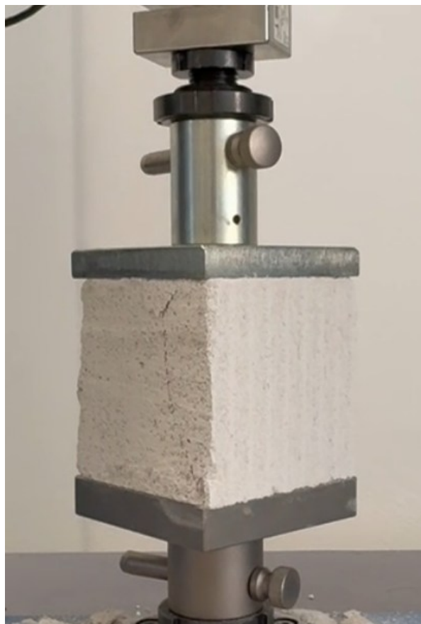
Obrázek 19 Prasknutí pórobetonu při zkoušce tlakem
