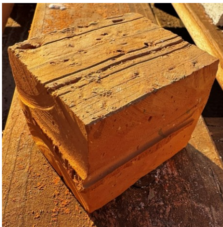
Obrázek 14 Zkušební vzorky pálené cihly o rozměrech 70×70×70 mm
