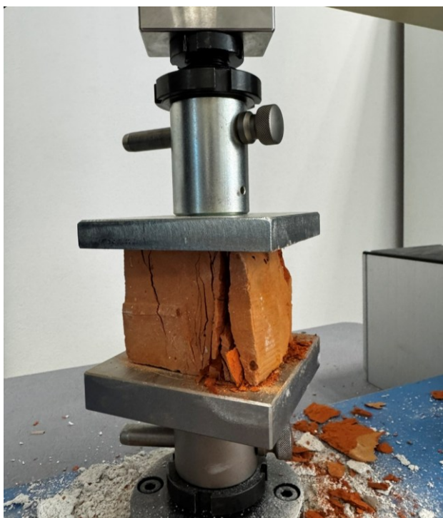
Obrázek 18 Prasknutí pálené cihly při zkoušce tlakem
