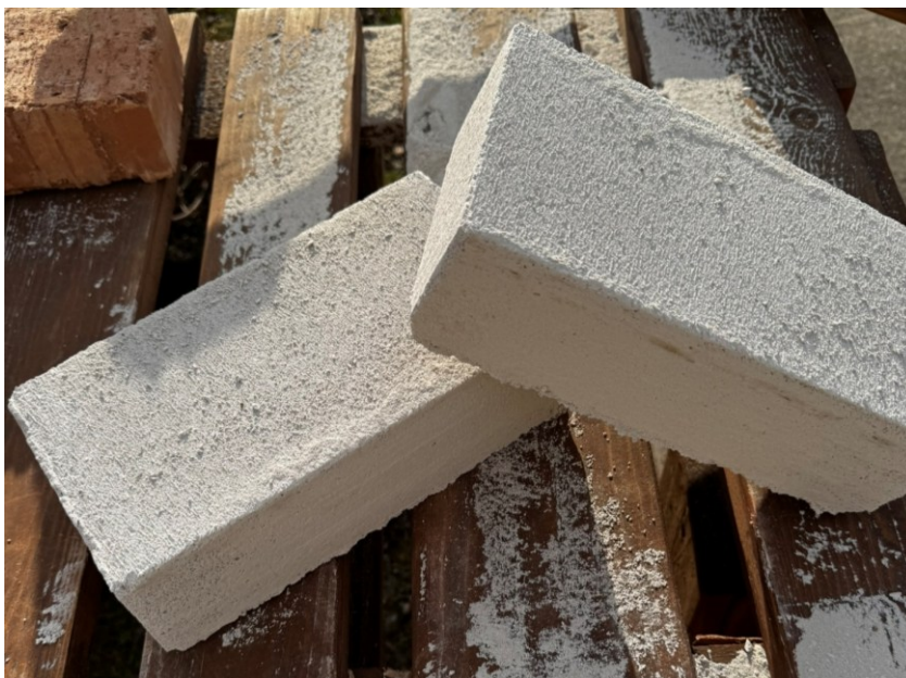
Obrázek 16 Zkušební vzorky Ytongu v rozměrech 290×140×65 mm
