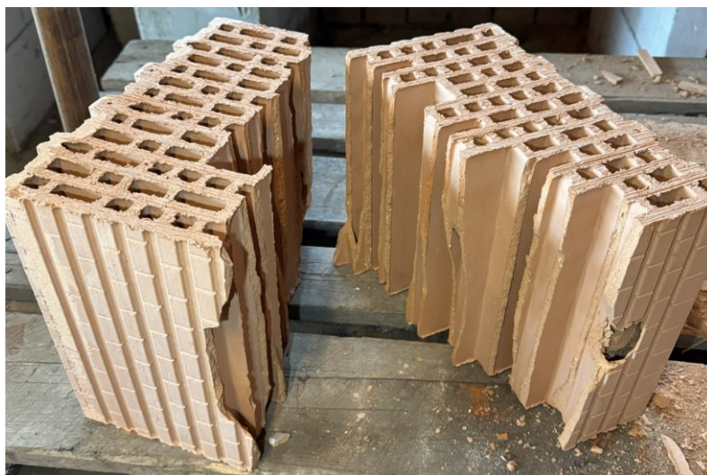
Obrázek 27 Výsledné rozlomení keramické pálené cihly
