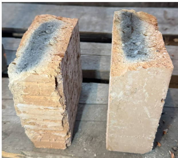
Obrázek 26 Výsledné rozlomení nové pálené cihly
