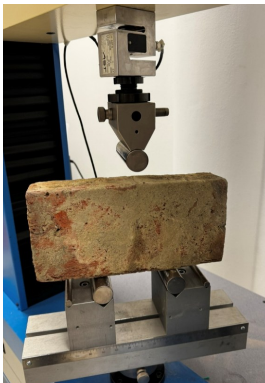
Obrázek 21 Zkouška ohybem – Stará pálená cihla
