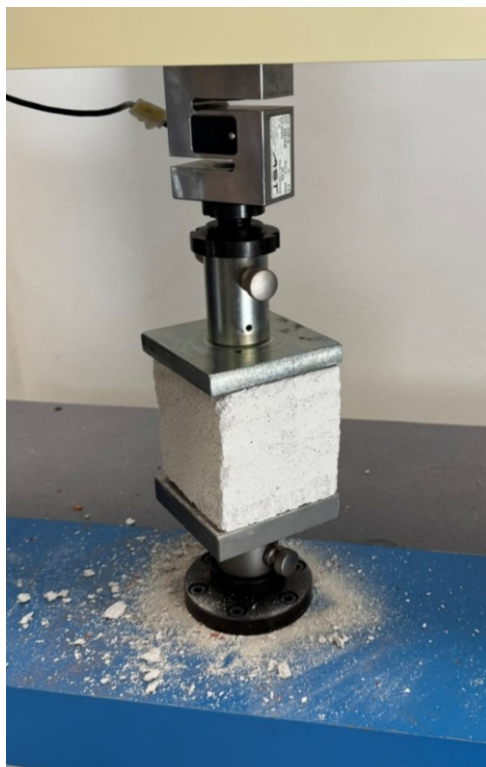
Obrázek 8 Zkouška pevnosti v tlaku
