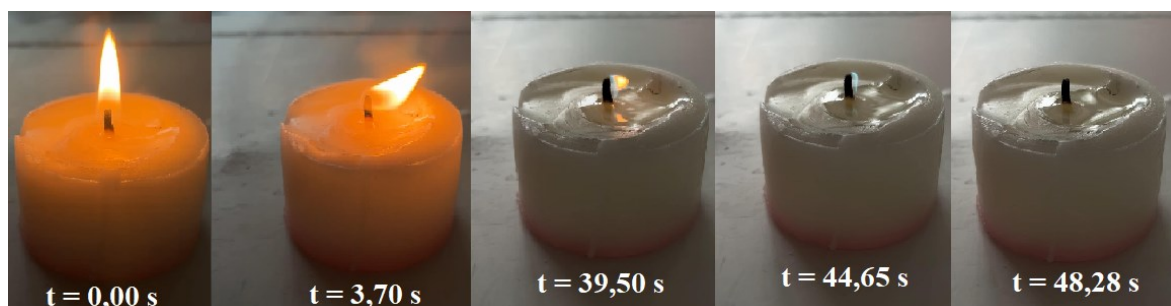
Obrázek 17 Průběh hašení svíčky při frekvenci 65 Hz a vzdálenosti 65 cm
