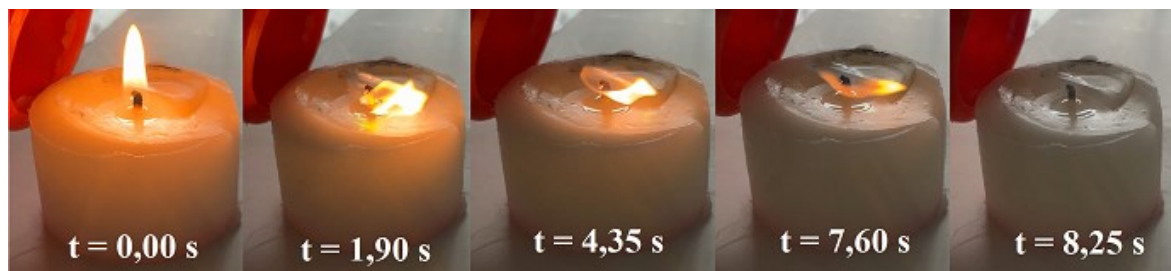
Obrázek 16 Průběh hašení svíčky při frekvenci 65 Hz a vzdálenosti 60 cm
