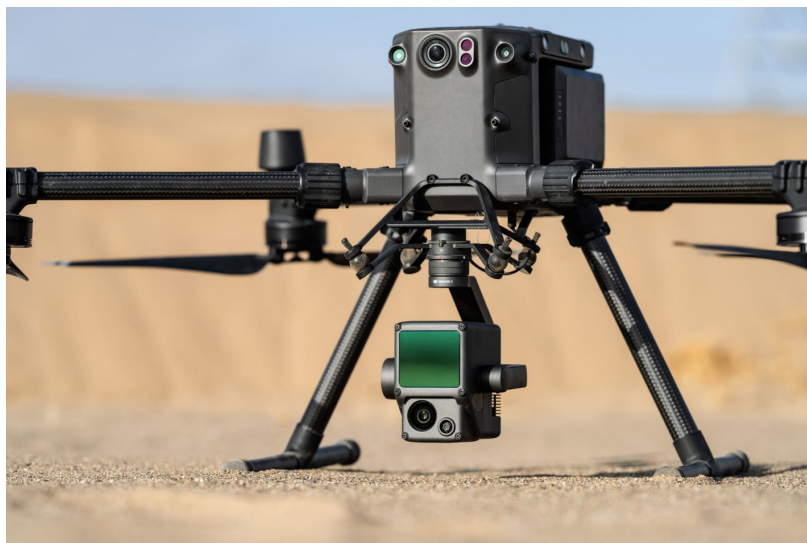
Obrázek 9 DJI Matrice 300 RTK s LiDAR DJI Zenmuse L1 [62]
