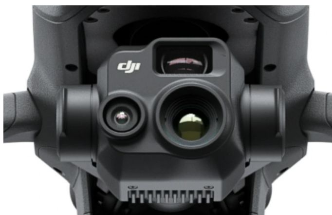
Obrázek 8 DJI Mavic 3 Thermal s integrovanou termovizní kamerou [59]
