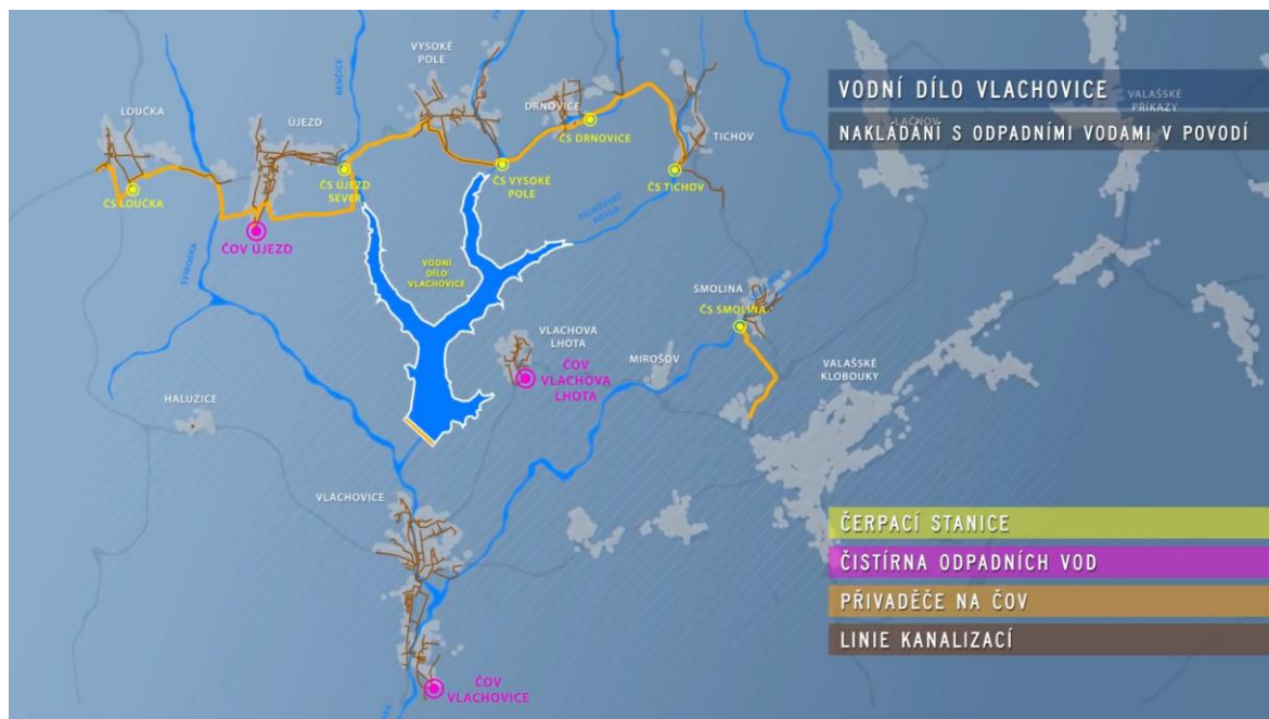
Obrázek 29 Předpokládaný stav hospodaření se splaškovou vodou po dokončení VD Vlachovice [84]
