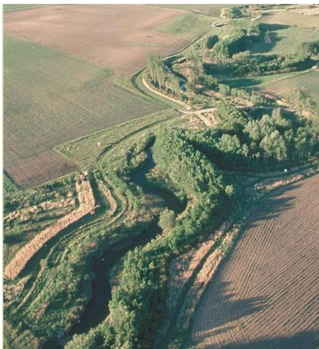
Obrázek 27 Ukázka zasakovacích a filtračních pásů kolem toku [91]
