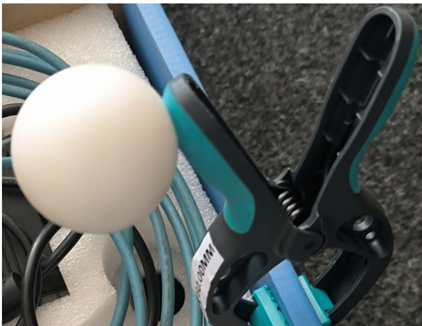
Obrázek 13 Kalibrační etalon (koule)
