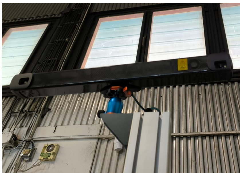
Obrázek 20 Upevnění kamerového systému
