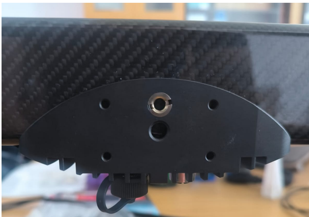
Obrázek 21 Montážní otvor kamery velikosti 3/8"
