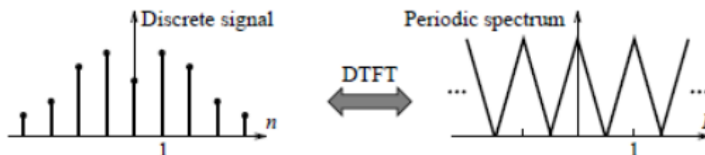
Obrázek 7 Převod signálu do frekvenčního spektra pomocí DTFT [11]
