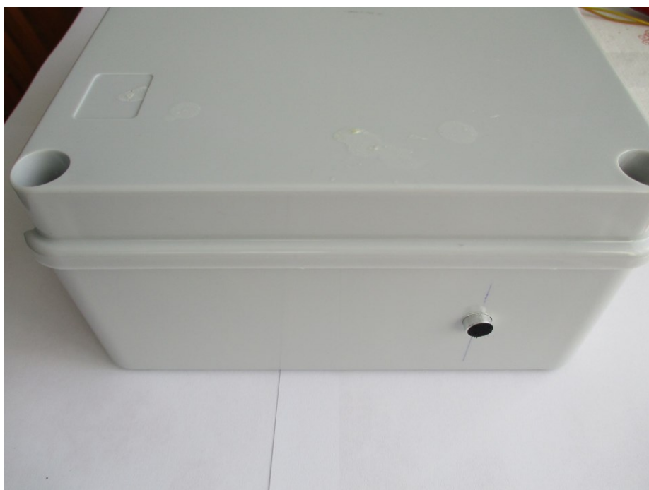
Obrázek 48 Krabice s elektronikou, dole vyvedený mikrofon [vlastní]
