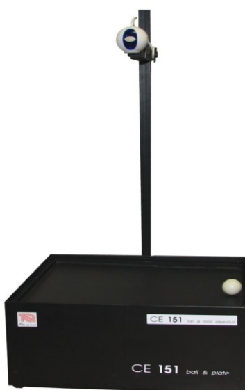
Obrázek 16. CE 151 Ball & Plate Model firmy Humusoft
