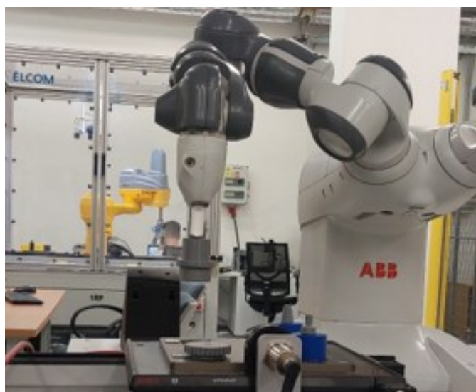
Obrázek 39 Zvednutí součástky do bezpečné zóny robotu ABB YuMi
