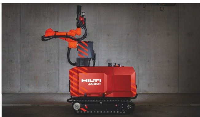
Obrázek 9 Vrtací robot Hilti Jaibot určený pro automatizované vrtání kotevních otvorů ve stavebnictví.
