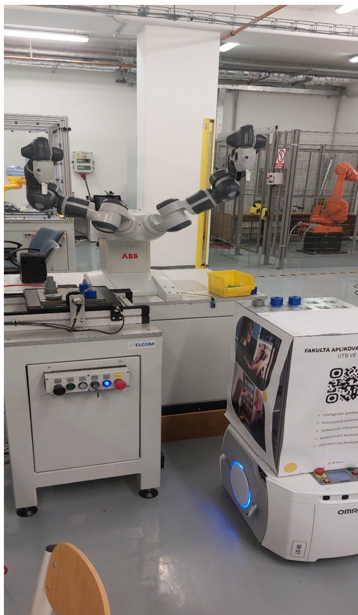
Obrázek 36 Přistavení robotu OMRON LD-90 k pracovnímu stanovišti a spuštění nakládkového procesu pomocí robotu ABB YuMi
