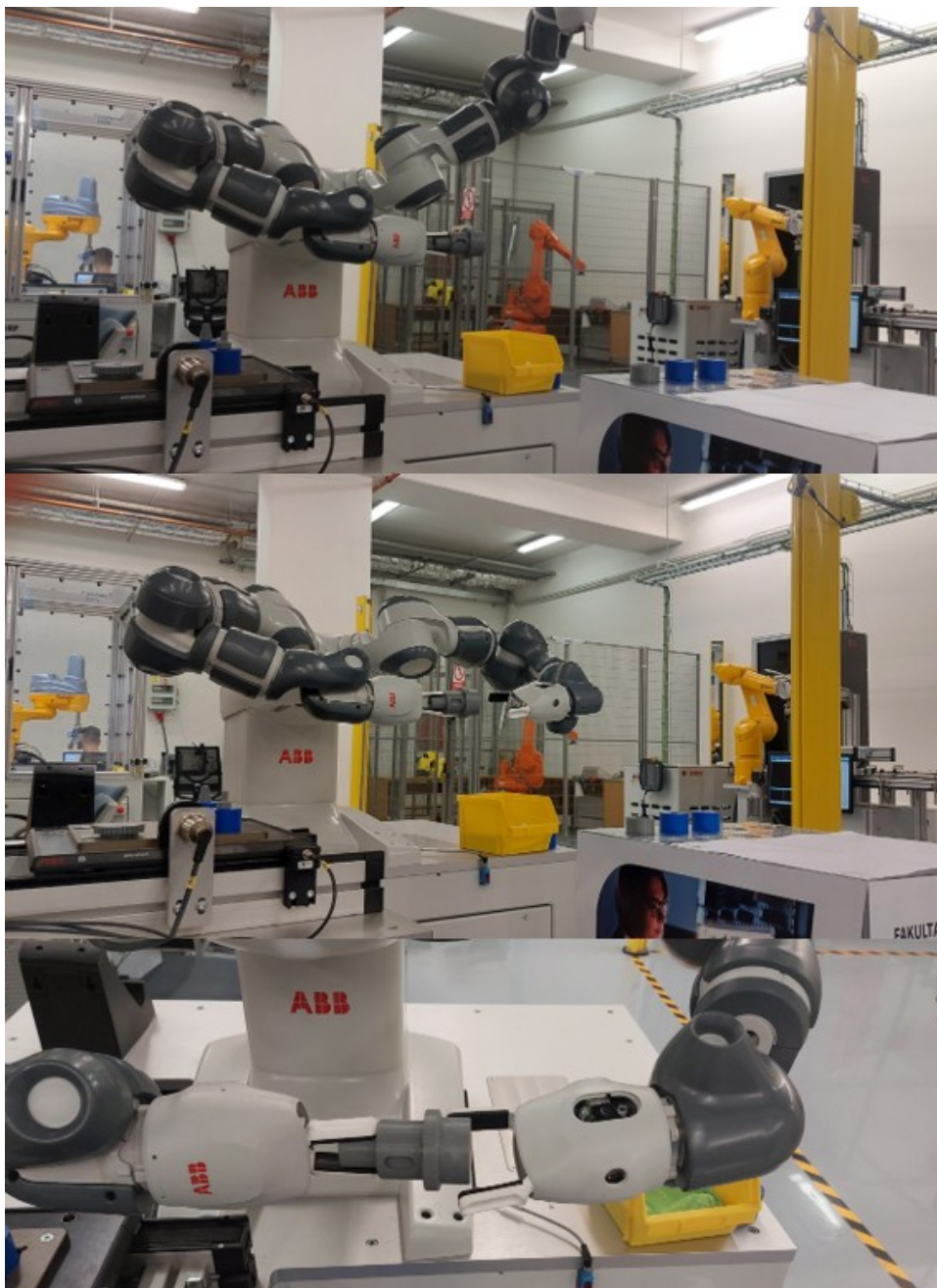
Obrázek 40 Přesun pravého ramene do pozice předání a aktivace levého ramene robotu ABB YuMi pro převzetí součástky
