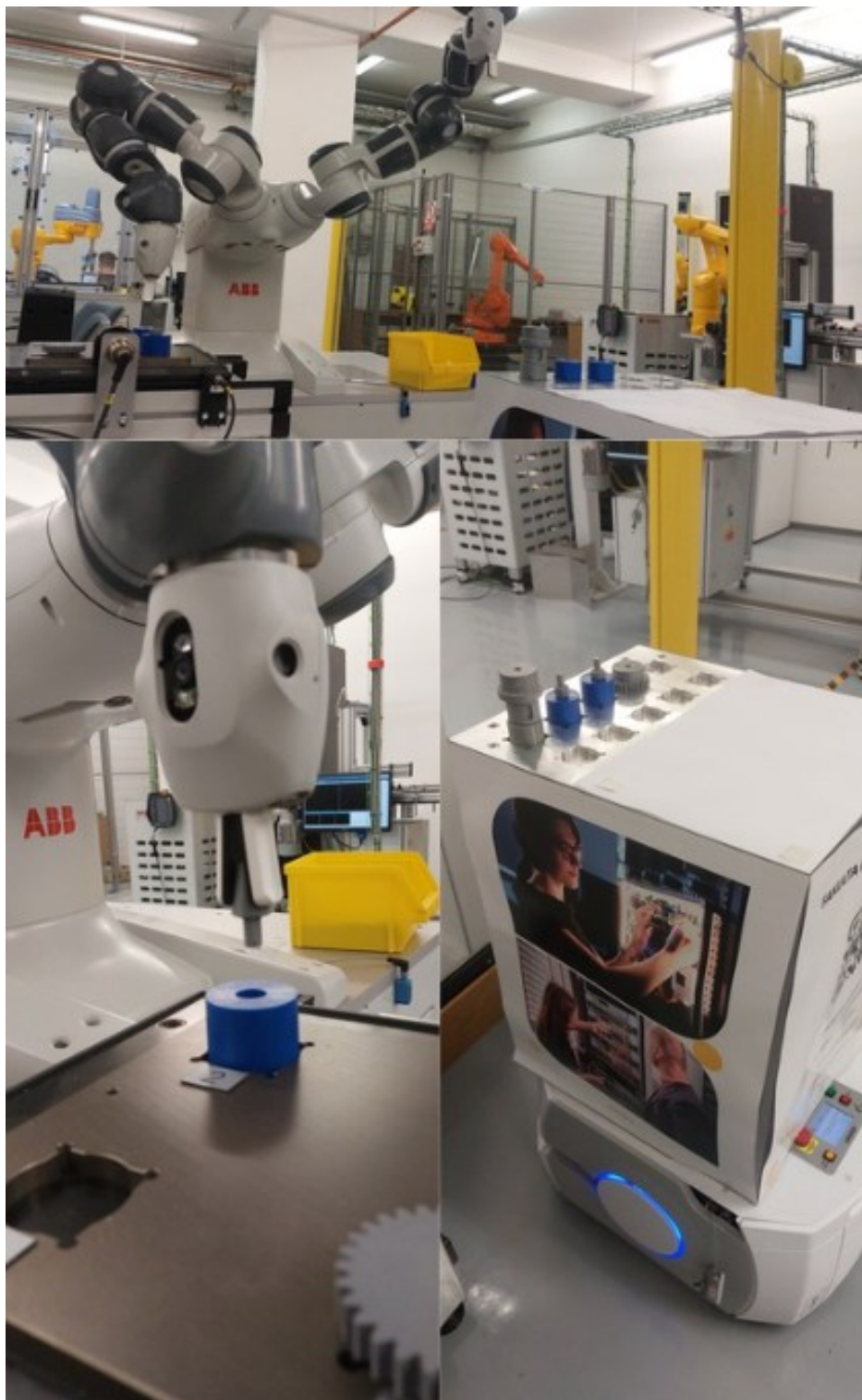
Obrázek 42 Proces nakládky více součástek robotem ABB YuMi a jejich uložení na mobilní robot OMRON LD-90 před odjezdem na další stanoviště
