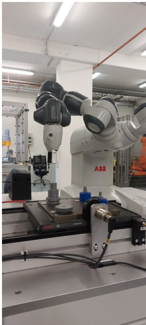
Obrázek 37 Přiblížení pravého ramene robotu ABB YuMi k první součástce a otevření uchopovače
