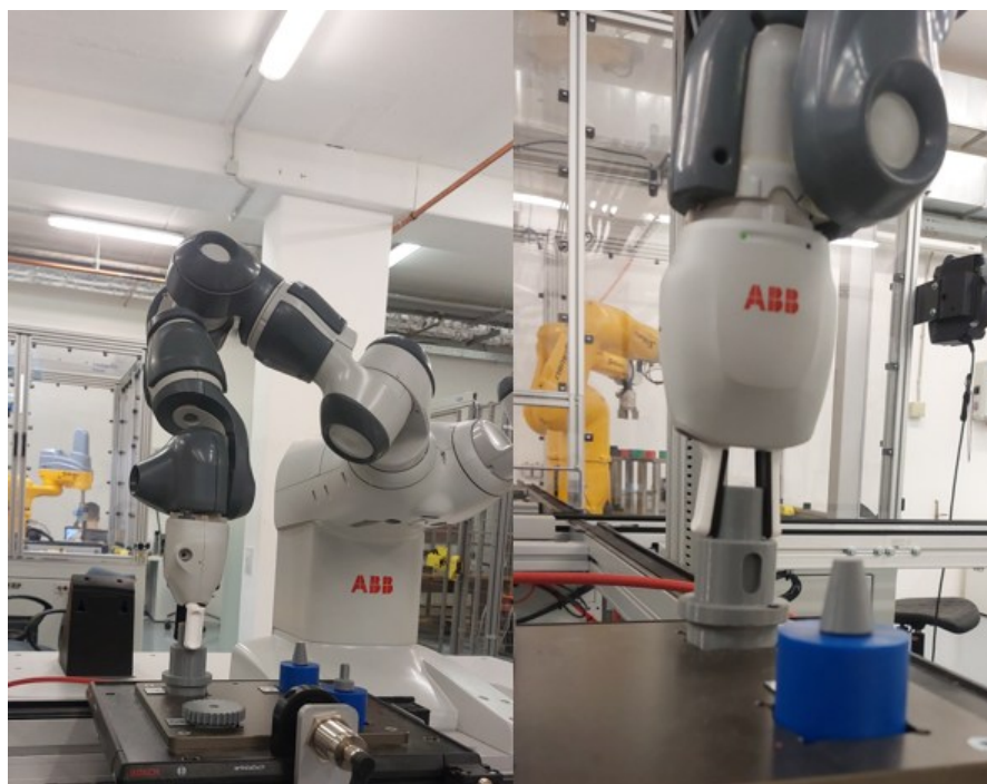
Obrázek 38 Uchopení součástky pravým ramenem robotu ABB YuMi
