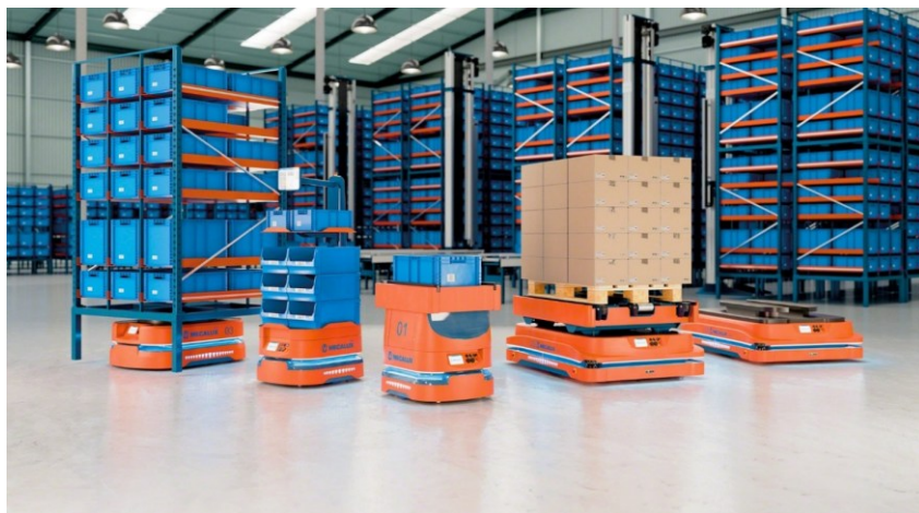
Obrázek 6 Autonomní mobilní roboty AMR společnosti Mecalux určené pro přepravu zboží ve skladu.
