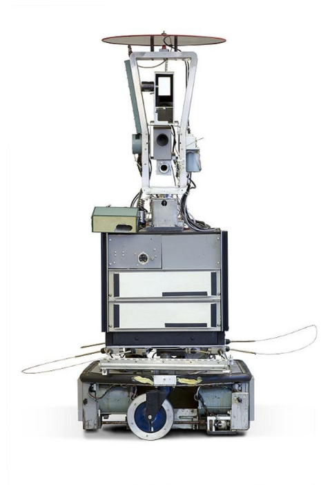
Obrázek 5 Robot Shakey – první mobilní inteligentní robot vyvinutý ve Stanford Research Institute (SRI International, 1966).
