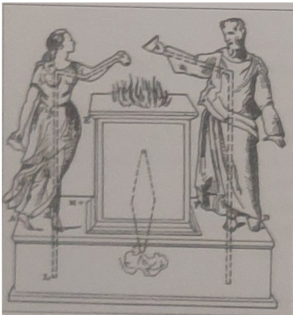
Obrázek 4 Příklad antického oltáře s figurínami, které samovolně vylévají vodu na obětní oheň
