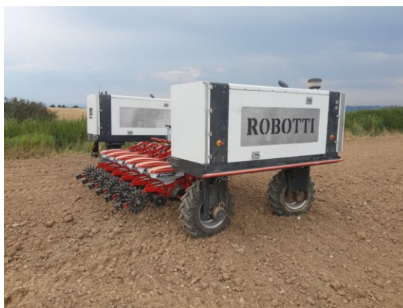
Obrázek 8 Autonomní polní robot Agroboti Robotti pracující na zemědělské půdě.
