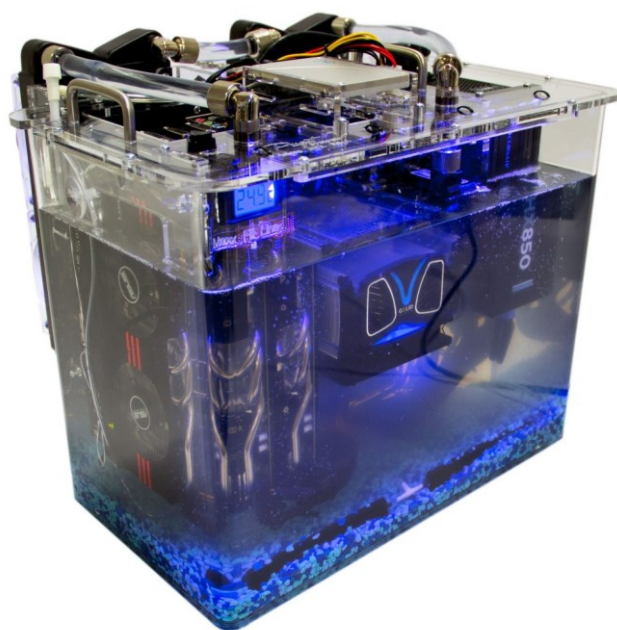
Obrázek 8 Stolní počítač chlazený minerálním olejem [27]
