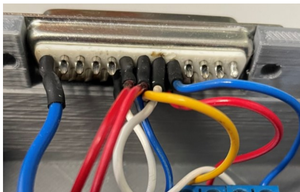
Obrázek 46: Umístění pinu na propojovací krabici pro PLC s modulem IC-1701
