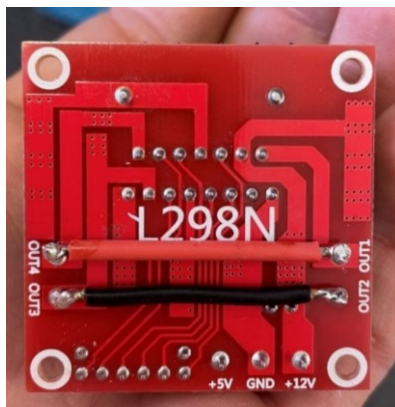
Obrázek 39: Paralelní zapojení výstupů modulu L298N
