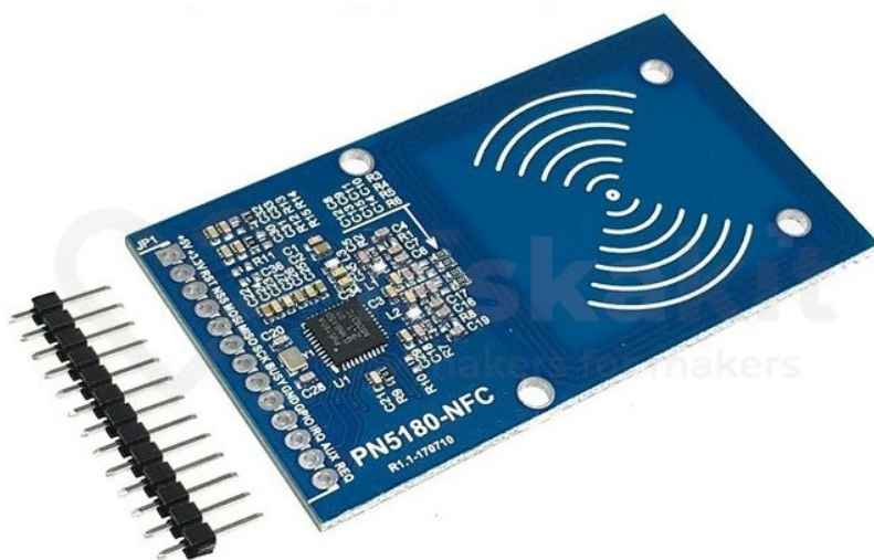
Obrázek 14: RFID modul PN5180 [34]
