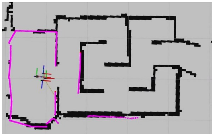
Obrázek 32 2D mapa vytvořená pomocí SLAM Toolbox
