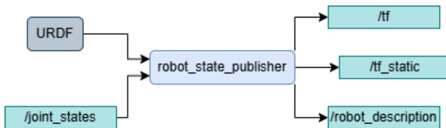
Obrázek 27 Schéma funkce Robot State Publisher
