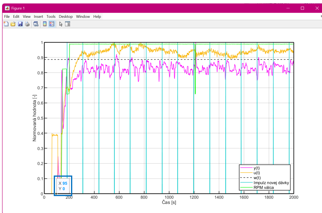
Obrázok 17 MATLAB zistenie začiatku nábehu v čase z grafu
