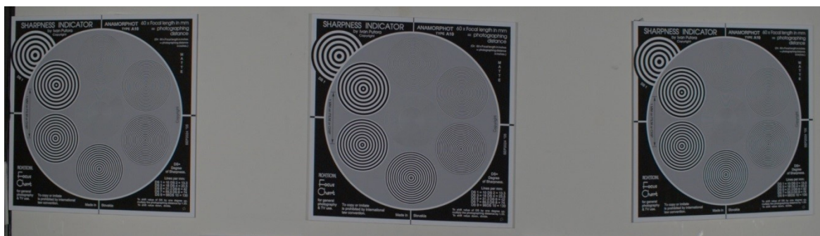
Obrázok 21 – Hawk C-series, 40mm, T5.6, minimálna deformácia obrazu, výborná ostrosť, takmer žiadna aberácia
