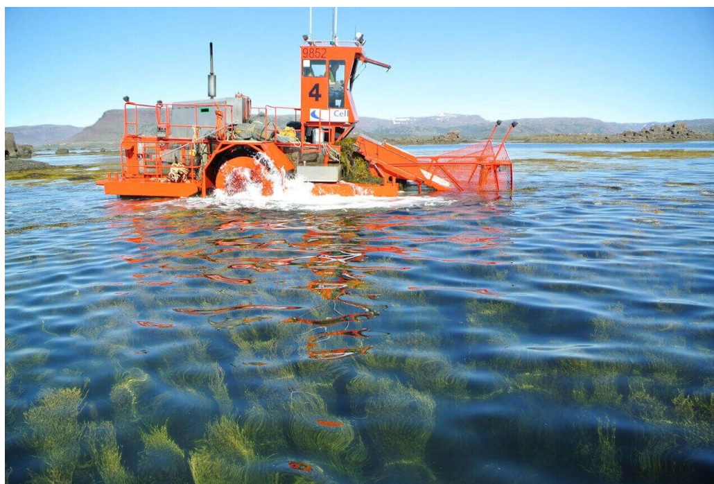
Obrázek 1 Proces sklizně mořských řas za pomoci speciálního stroje 11
