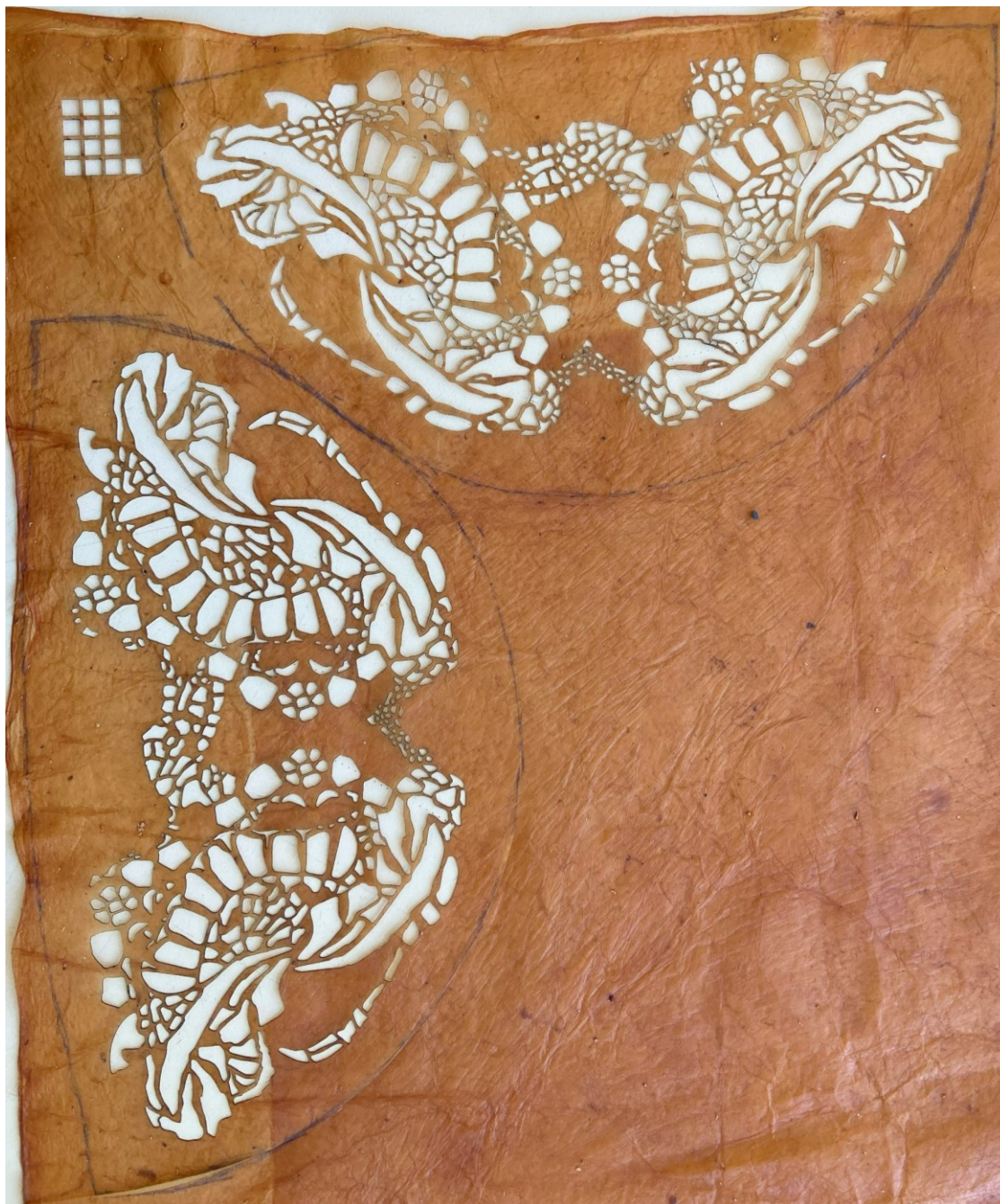
Obrázek 118 Vylaserovaný vzor do plátu bakteriální celulózy 293
