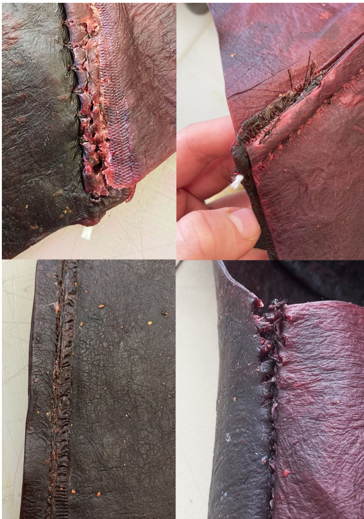
Obrázek 93 Poškození BC materiálu strojovým šitím 268
