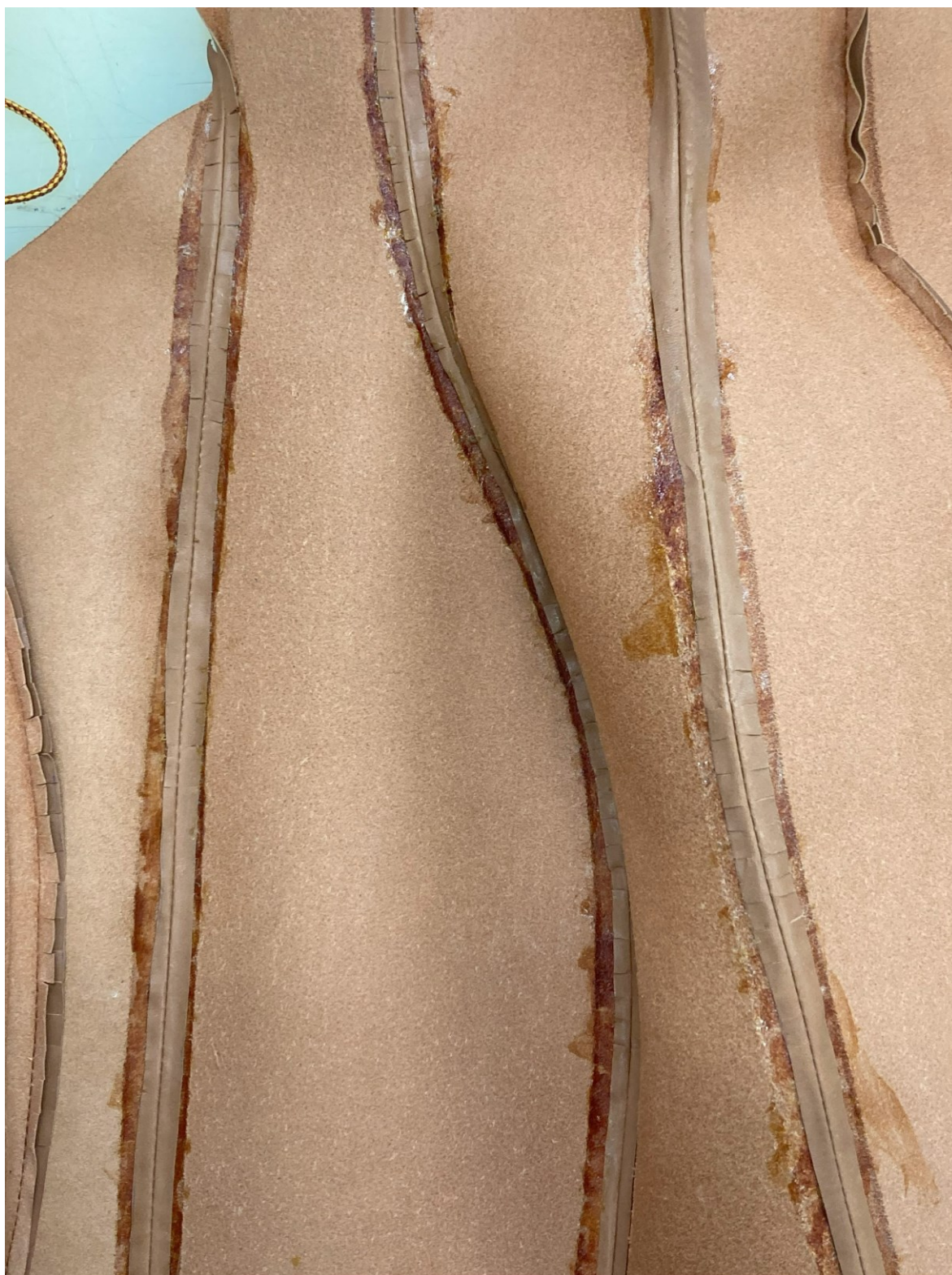
Obrázek 108 Proces zpracování švových záložek lepením – výroba šatů z usně 283
