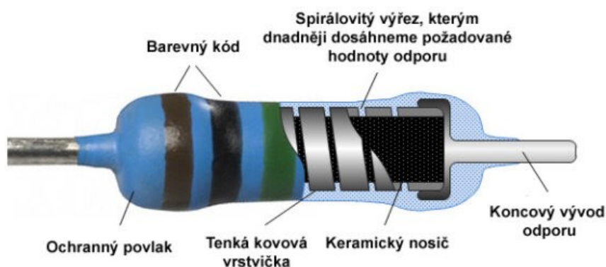
Obrázek 6 Popis konstrukce rezistoru
