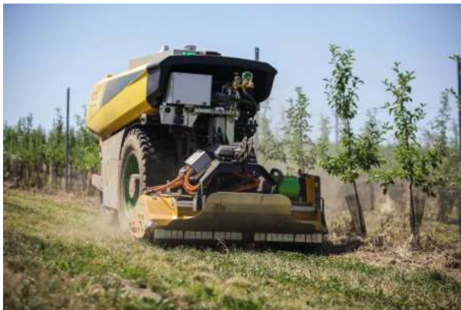
Obrázek 11 Servisní robot AgBot 2.055W3 od AGXeed určený pro sady a vinice [24]
