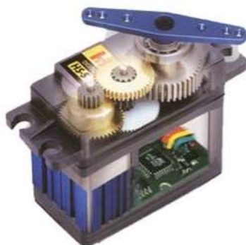
Obrázek 19 Servomotor s viditelnými vnitřními částmi [37]
