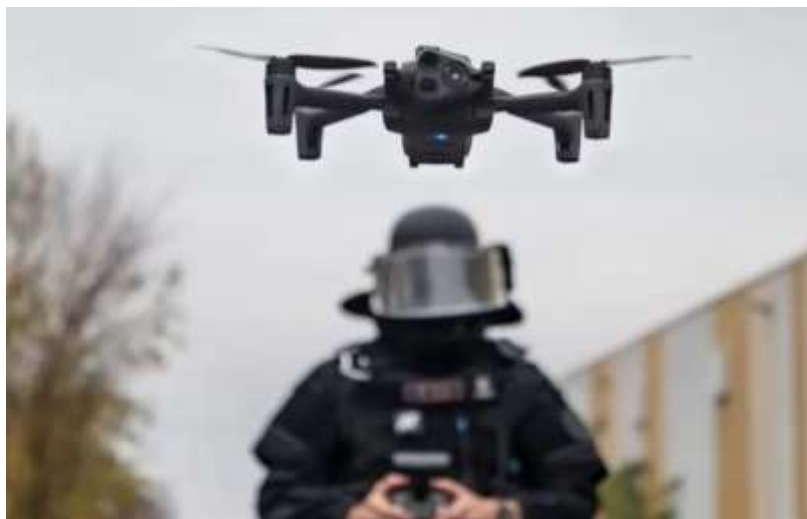
Obrázek 7 Bepilotní letoun Parrot Anafi USA s termovizí pro záchranné služby [21]
