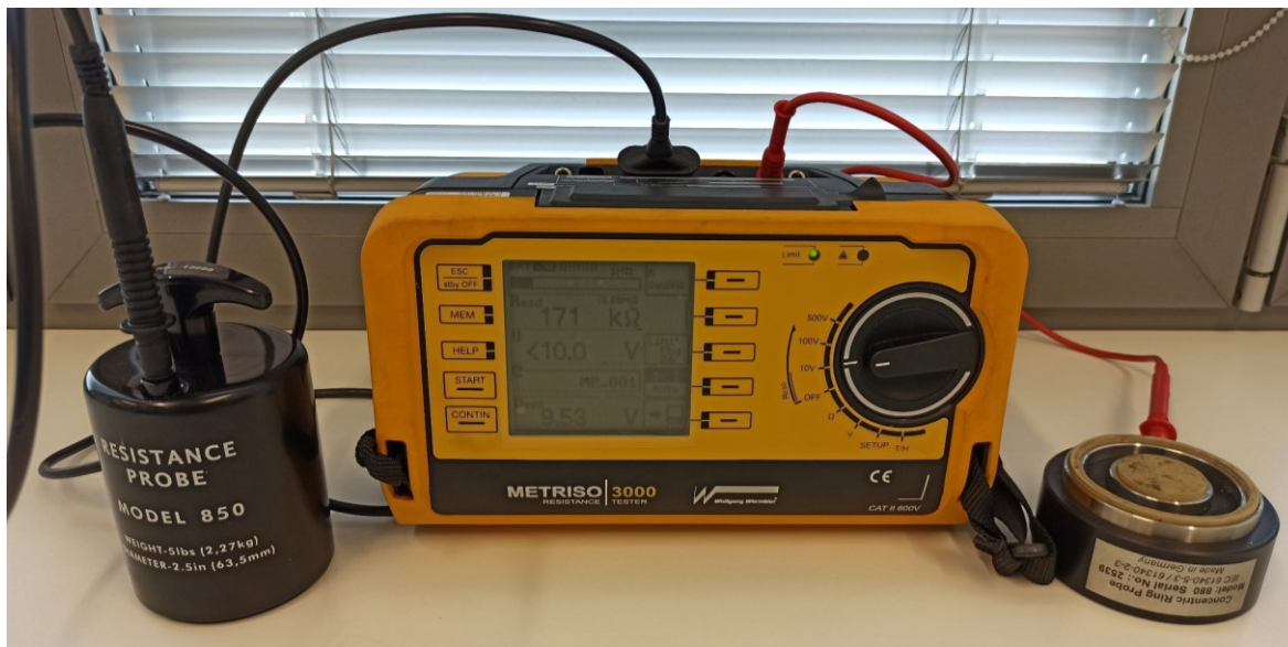
Obrázek 33: TeraOhmmetr Warmbier MetrISO 3000 zapojený pro měření objemové rezistivity
