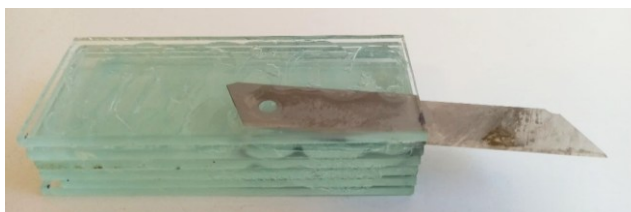
Obrázek 58: Břitva použitá pro rozpůlení silikonové formy
