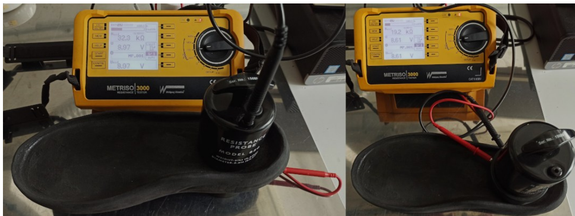
Obrázek 66: Měření průchozí (vlevo) a plošné (vpravo) rezistence podešve
