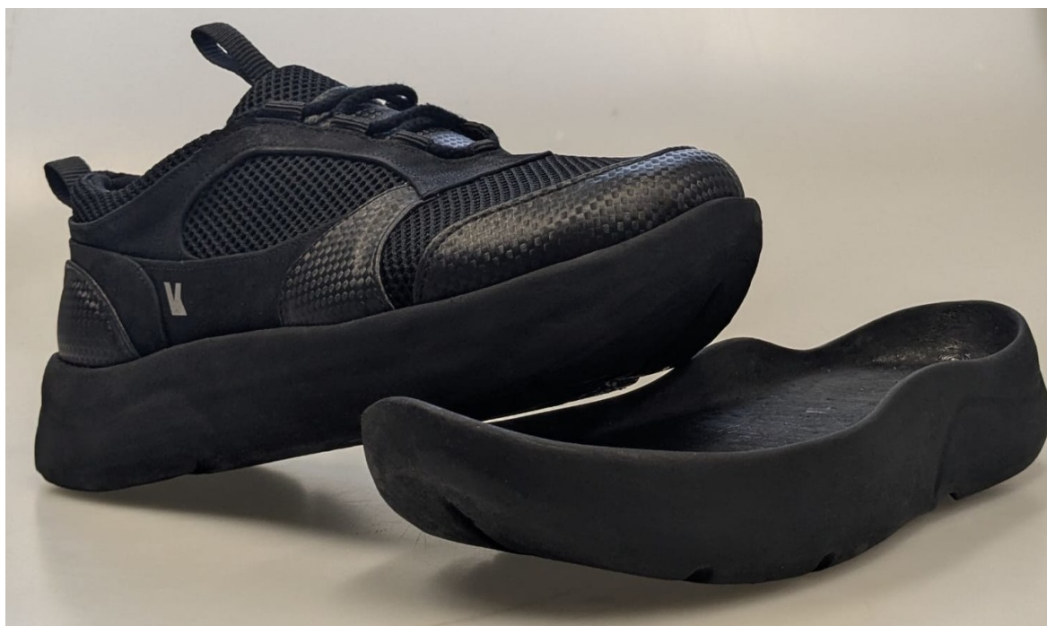
Obrázek 67: Antistatická podešev (vlevo) přiložená ke svršku boty a ukazková podešev bez antistatických vlastností (vpravo)
