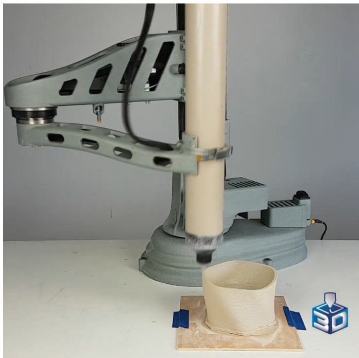
Obrázek 19: 3D tisk za pomoci robotické ruky SCARA [28]
