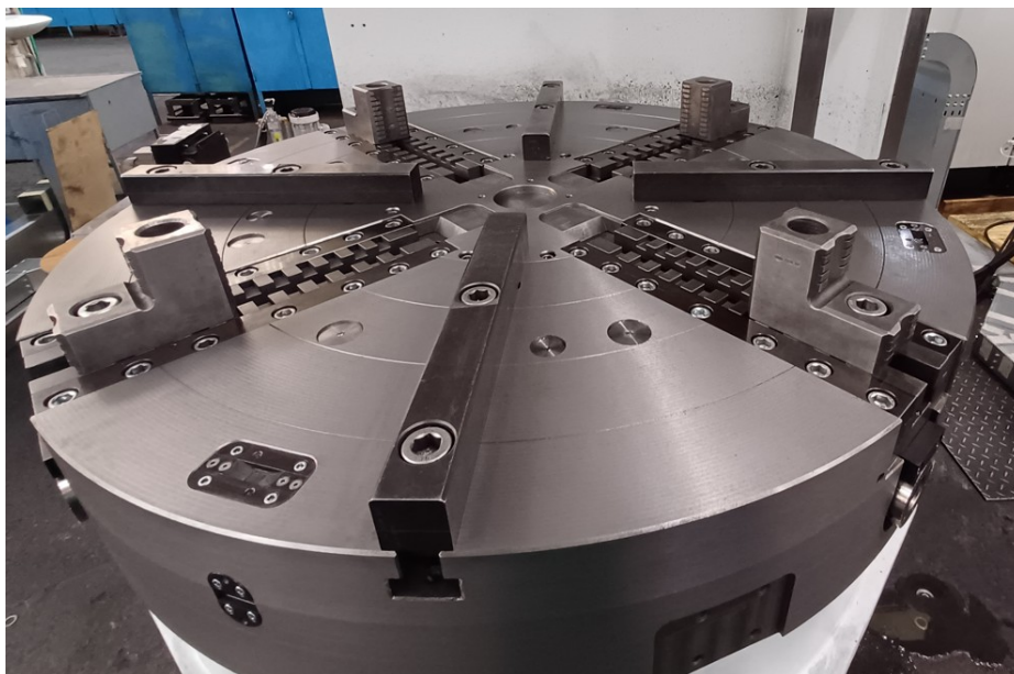
Obrázek 15 Čelisti na upínací desce stroje
