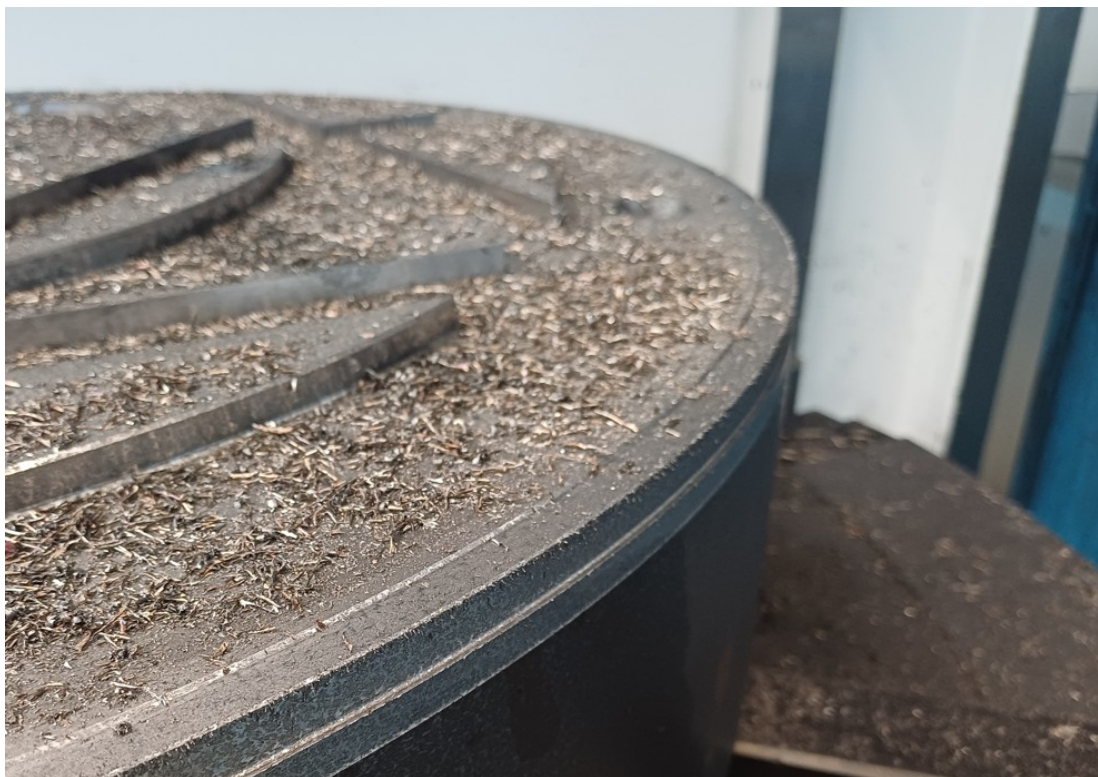
Obrázek 23 Soustružení čela a průměru na zkušebním dílci pro 3D měření
