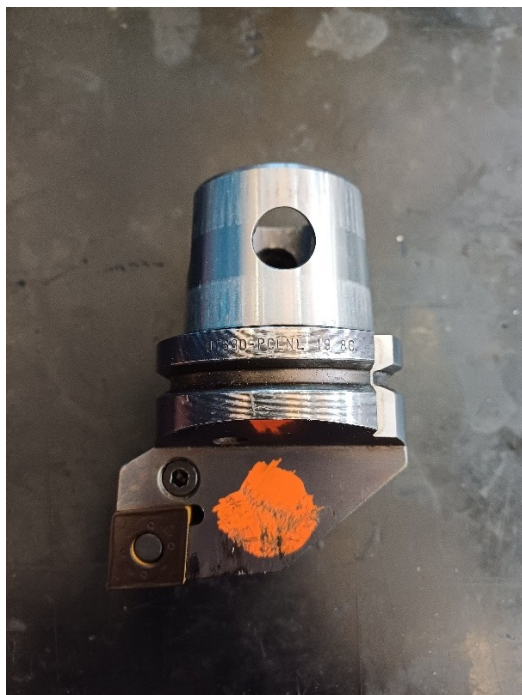
Obrázek 17 Soustružnický nůž používaný během zkoušky
