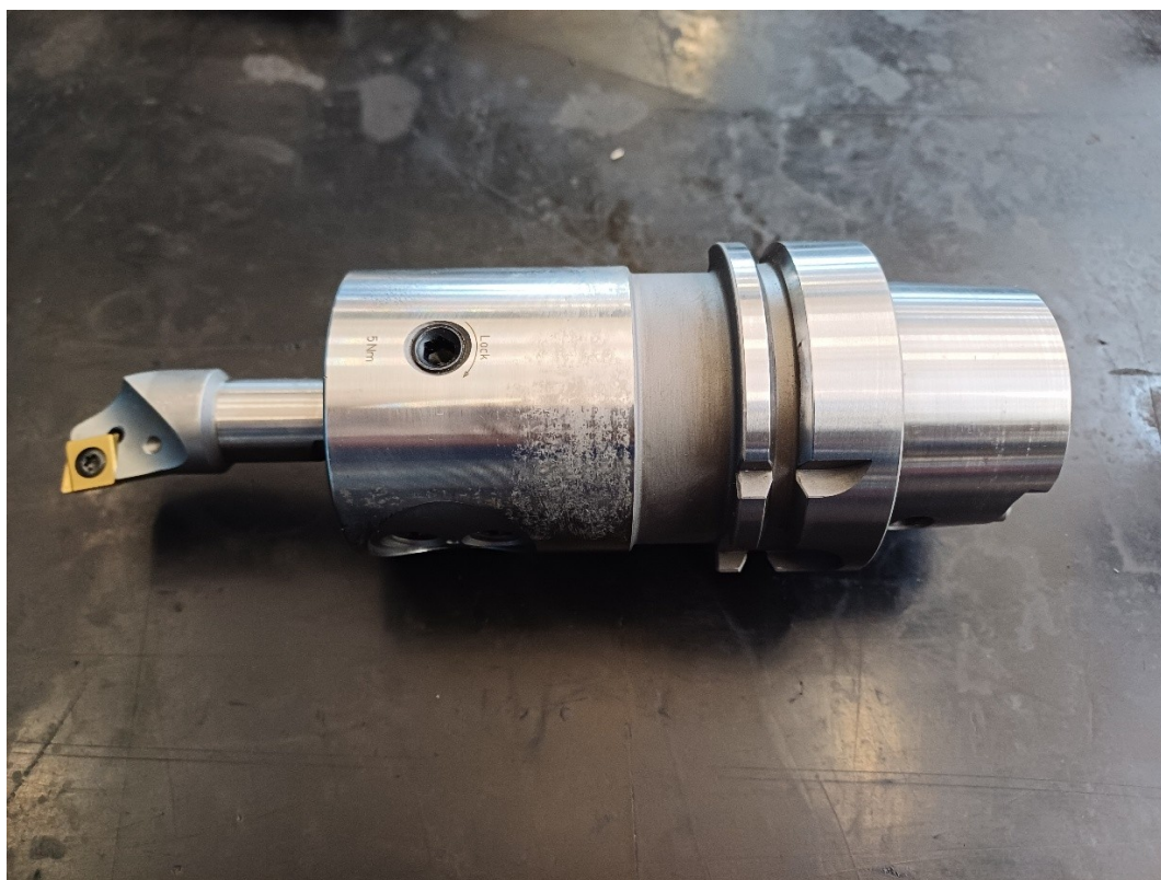
Obrázek 19 Vyvrtávací hlava HSK63 používaná během zkoušky
