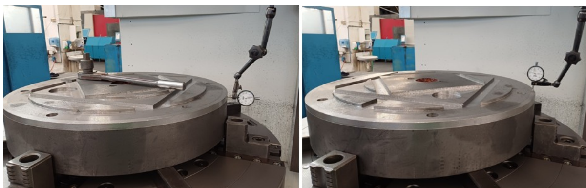
Obrázek 16 Kontrola obvodového a rovinného házení
