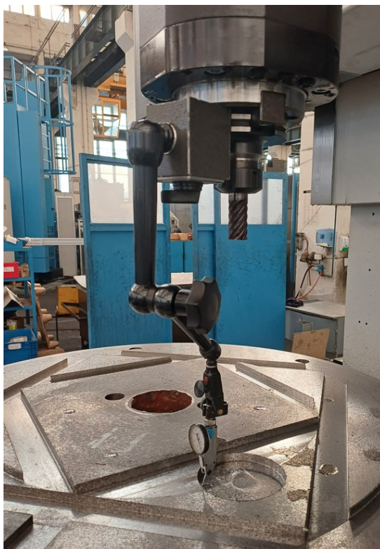
Obrázek 21 Přeměření kruhové kapsy po frézování
