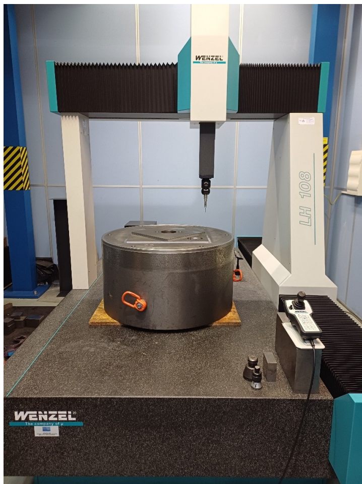
Obrázek 24 Měření zkušební díle NASa na měřicím stroji
