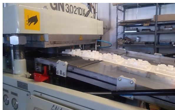
Obr. 53: Vytlačená fólie (tl. cca 0,50 mm). Obr. 54: Tvarovací stroj GN 3021 DX.
