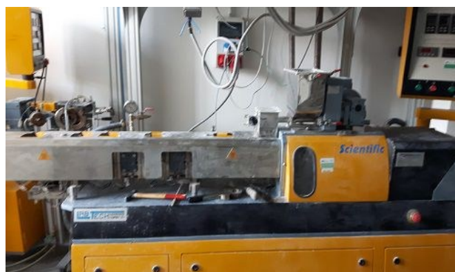
Obr. 42: Dvoušnekový vytlačovací stroj Ø 26 mm, LTE 26 (LabtechEngineering).
