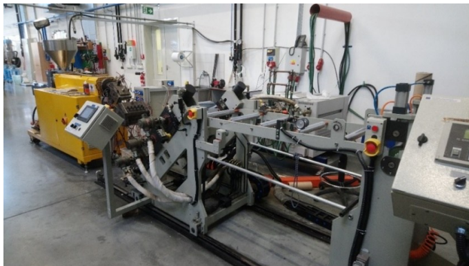
Obr. 47: Vytlačovací linka s plochou hlavou, chladícími válci, dopravníkem a navijecím zařízením.
