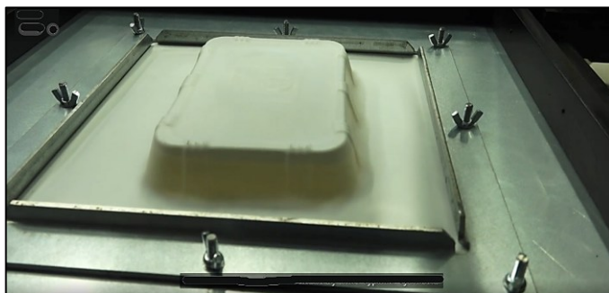
Obr. 52: Pozitivní tvarování na tvárníku (forma). Vakuové tvarovací zařízení (Evoko s.r.o., Vyskeř, Česká republika) – předehřev fólie 85 °C, doba 5 s, tvarování při 130 °C, doba 30 s.
