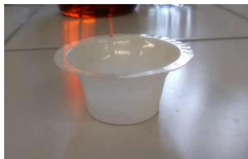
Obr. 61: Temperované vzorky připravené z vytlačené fólie: a) PLA 2003 D pure a b) PLA 2003 D + 10 % CaCO 3 + 4 % PLA/PEG
