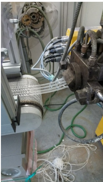
Obr. 44: Poloprovozní linka - dvoušnekový vytlačovací stroj Ø 26 mm, vytlačovací hubice, dopravník se vzduchovým chlazením a nožový mlýn.
