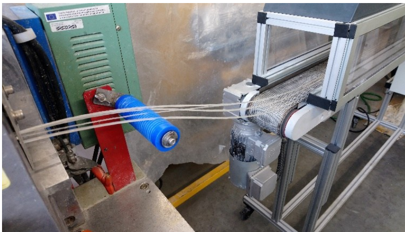
Obr. 44: Poloprovozní linka - dvoušnekový vytlačovací stroj Ø 26 mm, vytlačovací hubice, dopravník se vzduchovým chlazením a nožový mlýn.
