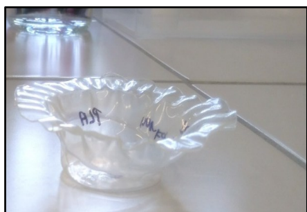
Obr. 61: Temperované vzorky připravené z vytlačené fólie: a) PLA 2003 D pure a b) PLA 2003 D + 10 % CaCO 3 + 4 % PLA/PEG
