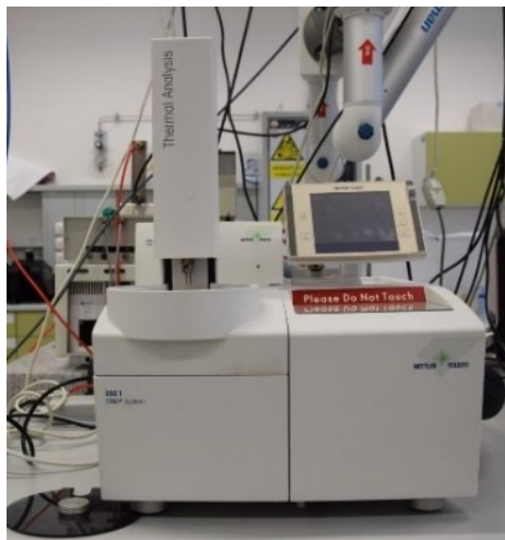
Obr. 4: Příklad DSC Mettler Toledo DSC1 Star.
