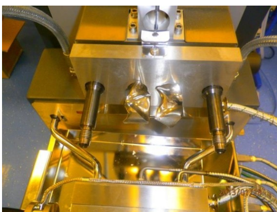
Obr. 25: Uložení hnětadel v komoře.
