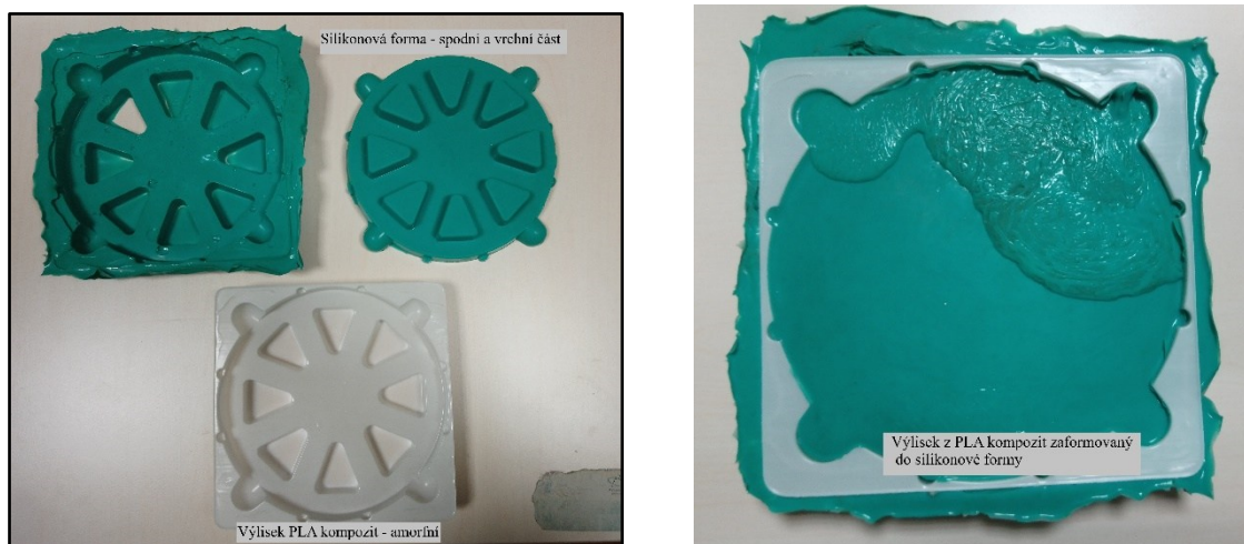
Obr. 66: Části silikonové formy (vrchní a spodní část) a zaformovaný výlisek ve formě.
