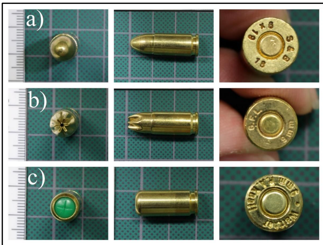
Obr. 1: Srovnání náboje a nábojek určené do pistolí: a) náboj ráže 9 mm Luger společnosti Sellier & Bellot, b) akustická nábojka ráže 9 mm × 19 Salve – Blank společnosti Fiocchi, c) akustická nábojka ráže 9 mm P.A.K. společnosti Walther.
