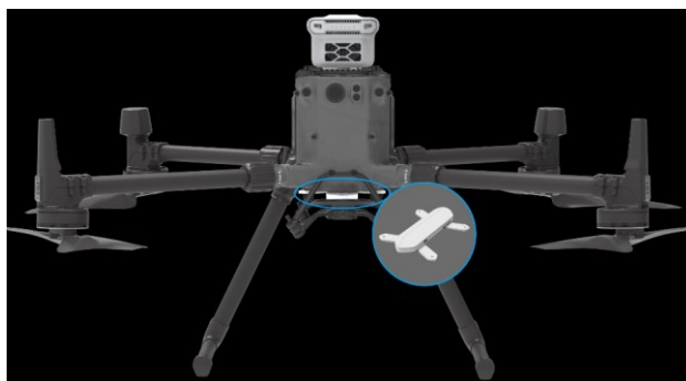
Obrázek 26 Umístění detekčního zařízení k bezpilotnímu letadlu (Nuclear Radiation Sensing, © 2023)
