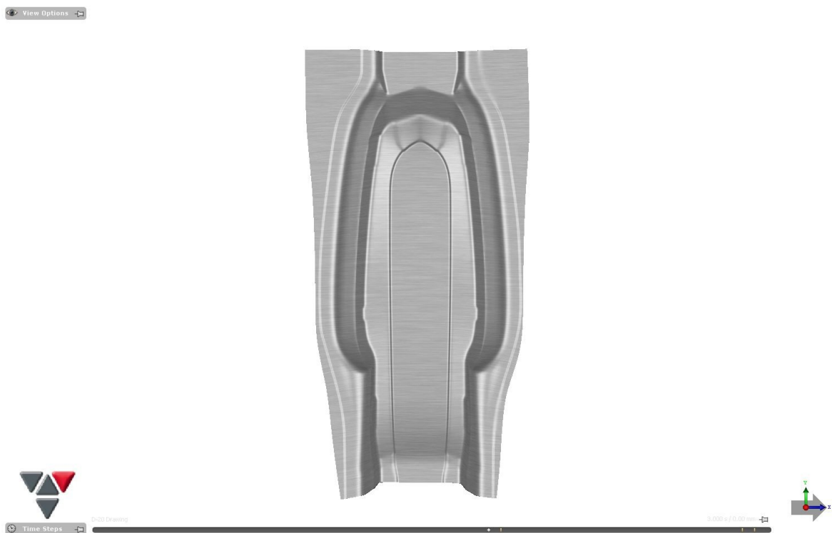
Obrázek 96 Platina po první operaci
