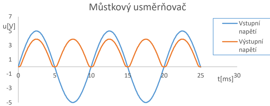
Graf č. 5: Charakteristika můstkového usměrňovače s filtračním kondenzátorem ( R_Z=10k\Omega )
