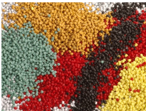
Obrázek 8 Granulát pro vstřikování [14]
