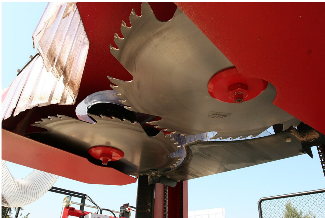
Obrázek 7 Kotouče oběžné pily na dřevo [5]
