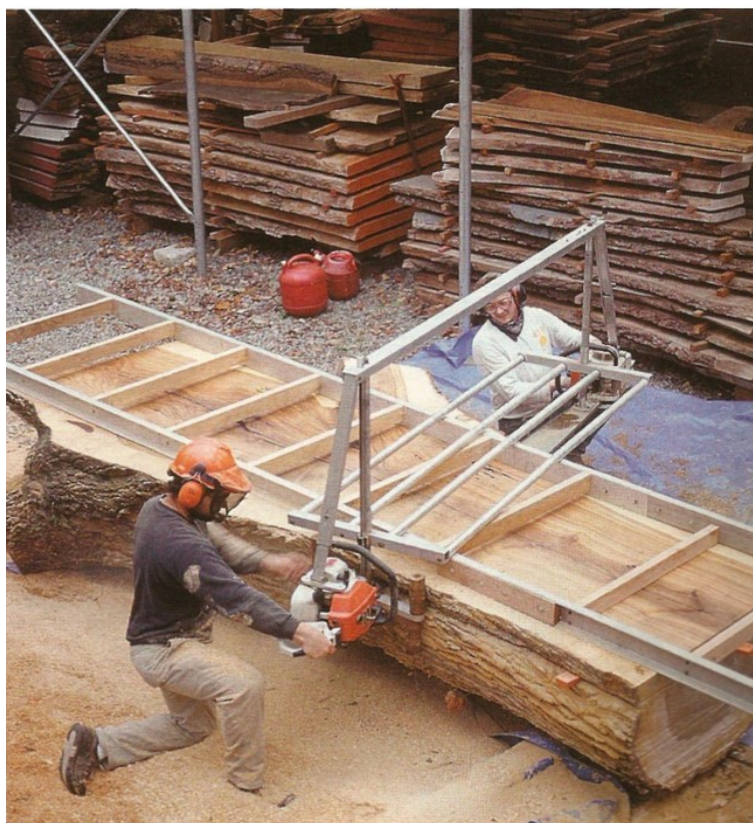
Obrázek 9 Řetězová pila – neukotvena [1]
