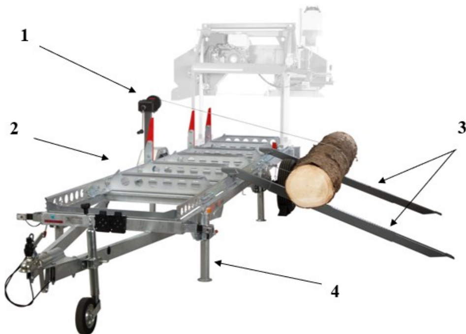
Obrázek 21 Schéma vozíku horizontální mobilní kmenové pásové pily [20]
