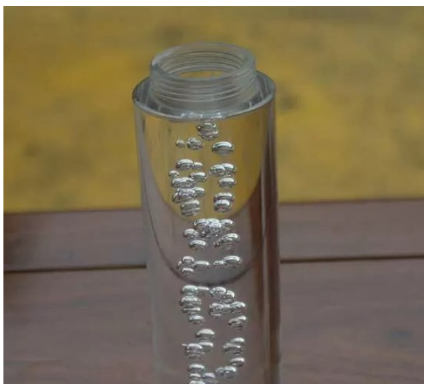
Obrázek 11. Vzduchové bubliny ve výstřiku [14]
