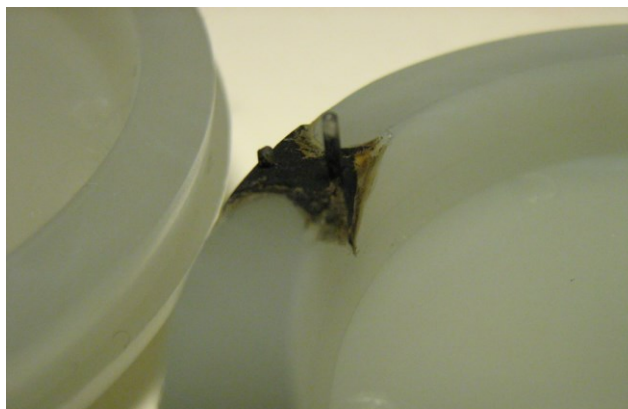
Obrázek 12. Spálené místo na výstřiku [15]
