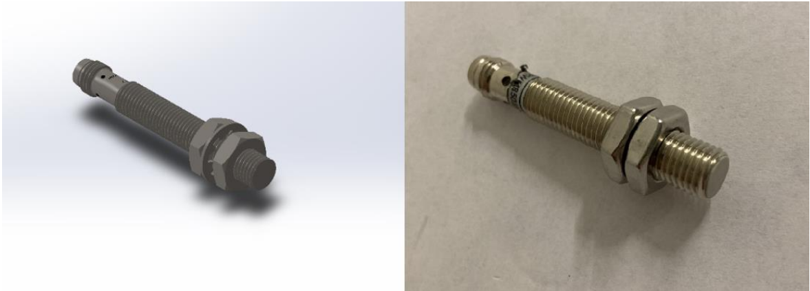
Obrázek 31: Virtuální (vlevo) a reálný (vpravo) indukční senzor
