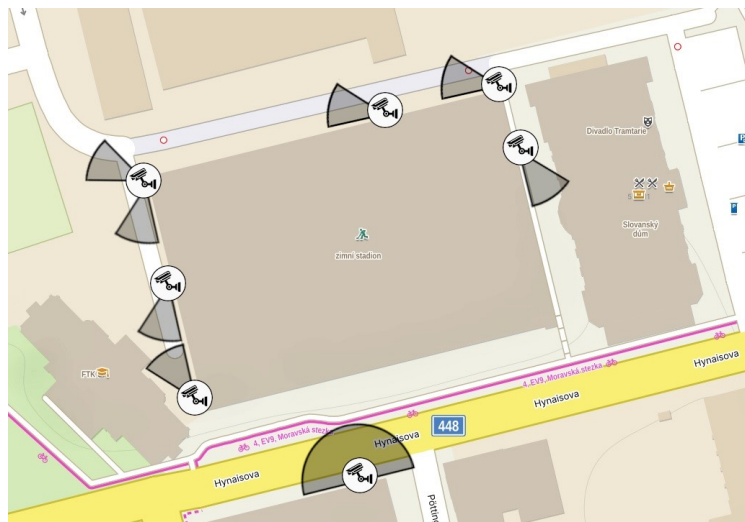
Obrázek 8 Rozmístění kamer na plášti stadionu. Upraveno z [30]
