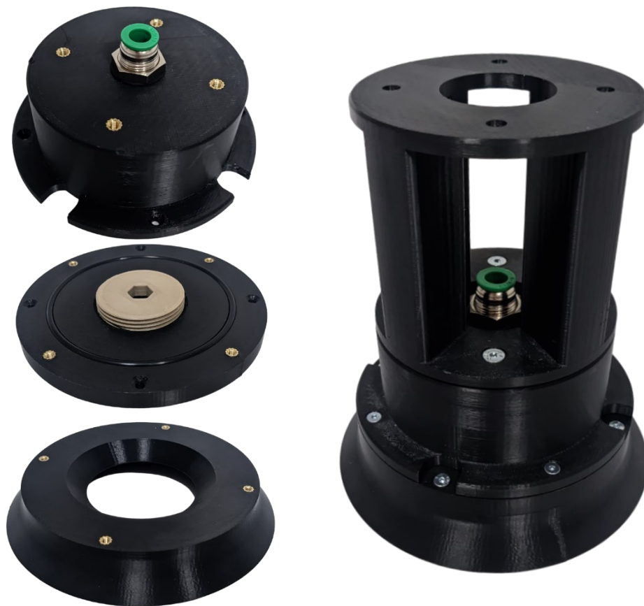
Obrázek 28: Pevné díly, ze kterých se skládá koncový efektor
