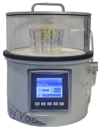
Obrázek 30: Příprava silikonu ve vakuové komoře
