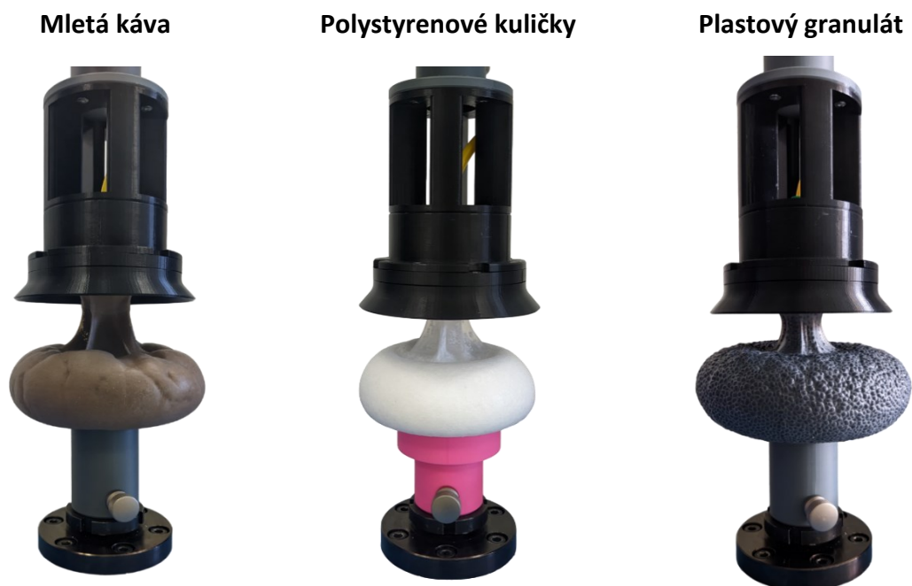
Obrázek 36: Ukázka natažení membrány u různých typů náplně membrány
