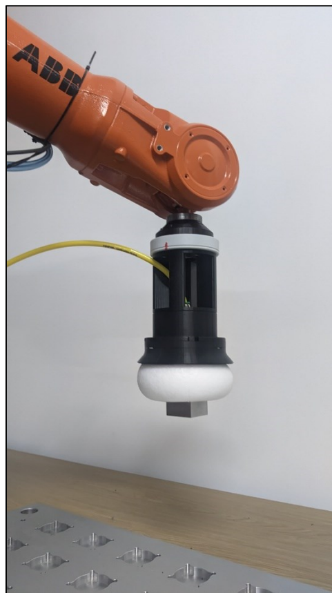
Obrázek 47: Testování životnosti membrány
