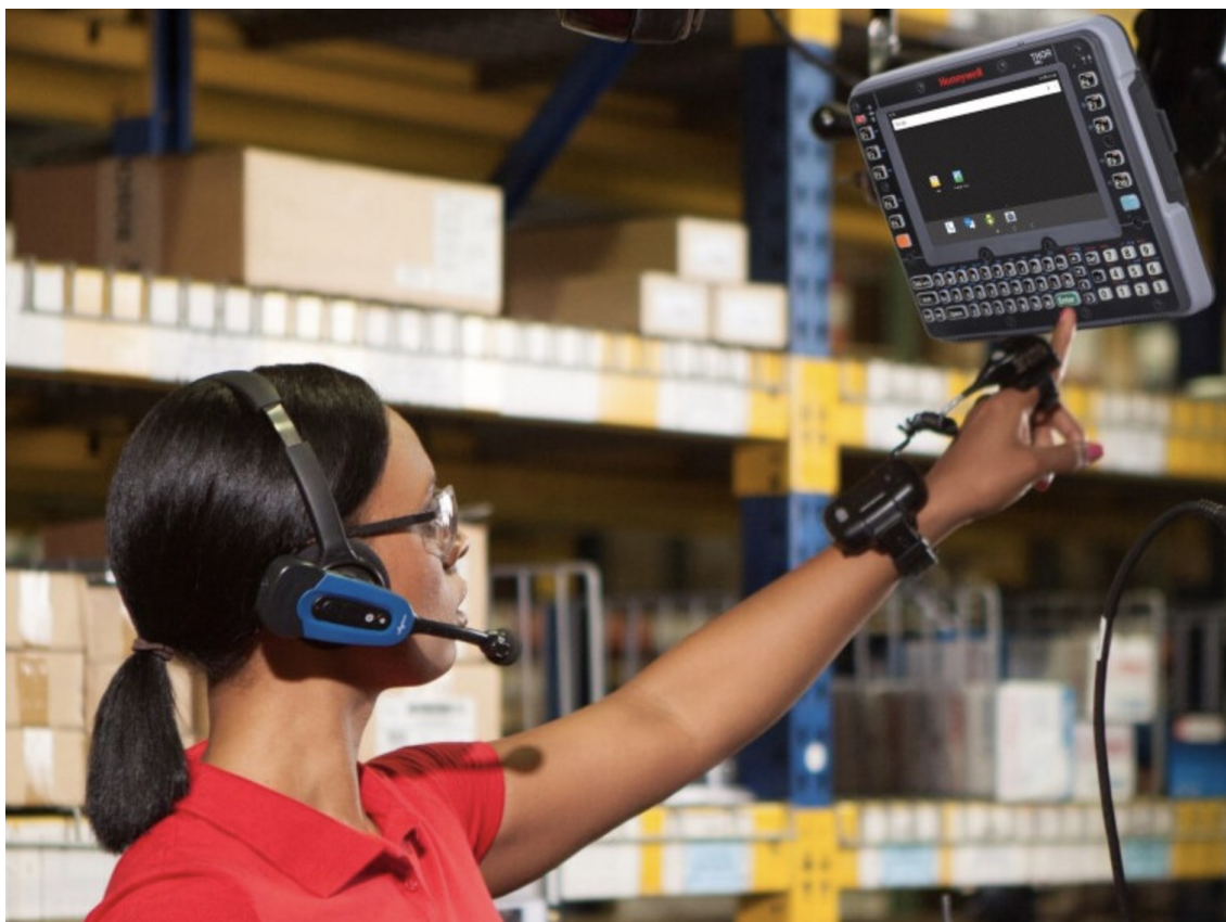
Obrázek 3 Pick-by-voice s využitím scanneru a terminálu (BSR idware GmbH)
