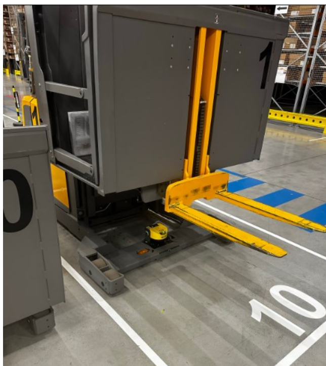
Obrázek 14 Systémový vozík s anti-kolizním systémem (vlastní zpracování – DHL s. r. o.)
