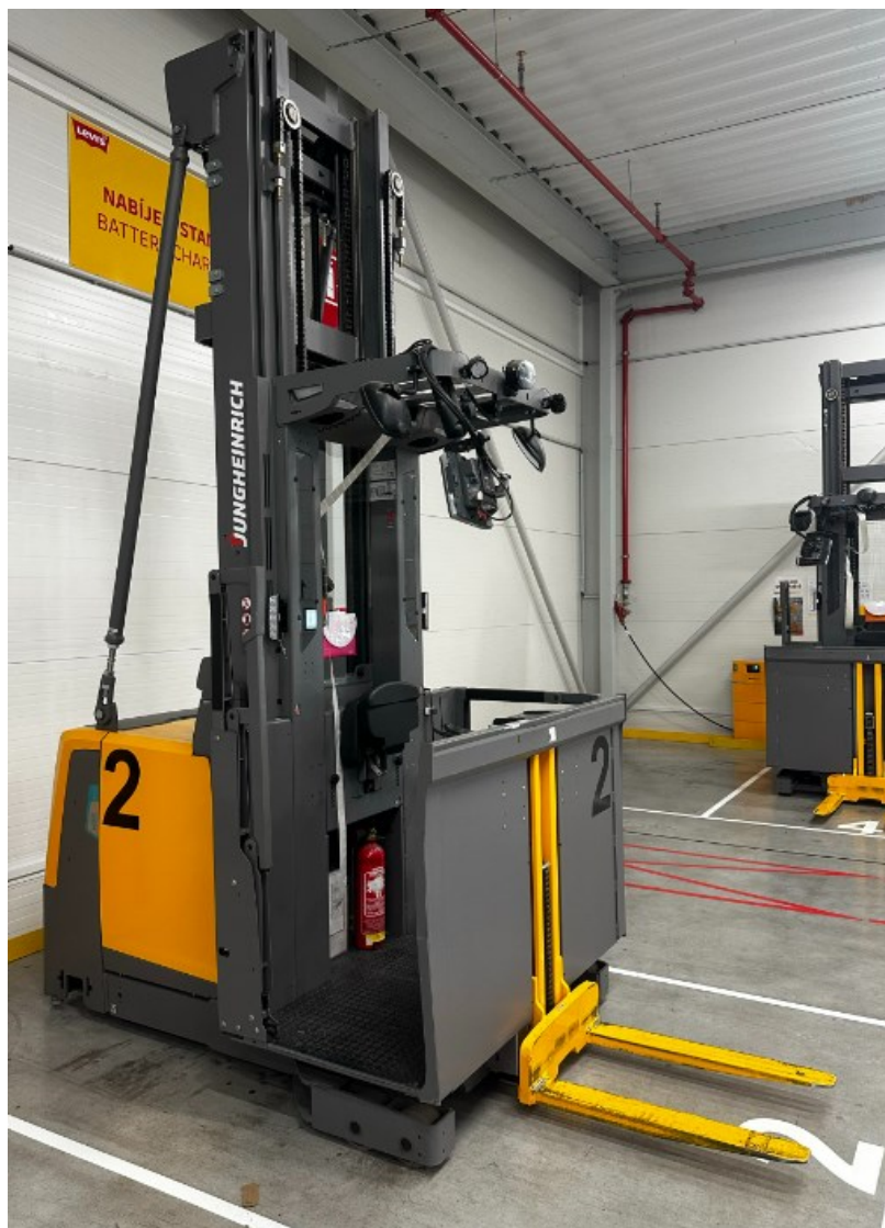
Obrázek 6 Systémový vozík model EKS (vlastní zpracování – DHL s. r. o.)
