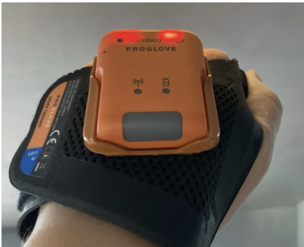
Obrázek 1 Ruční scanner Proglove Mark 2 (DaWaDes, © 2024)
