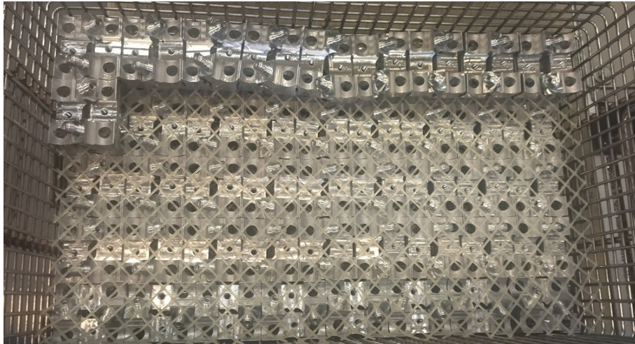
Obrázek 11 Skládání kusů do nerezových košů po racionalizaci (zpracování vlastní)
