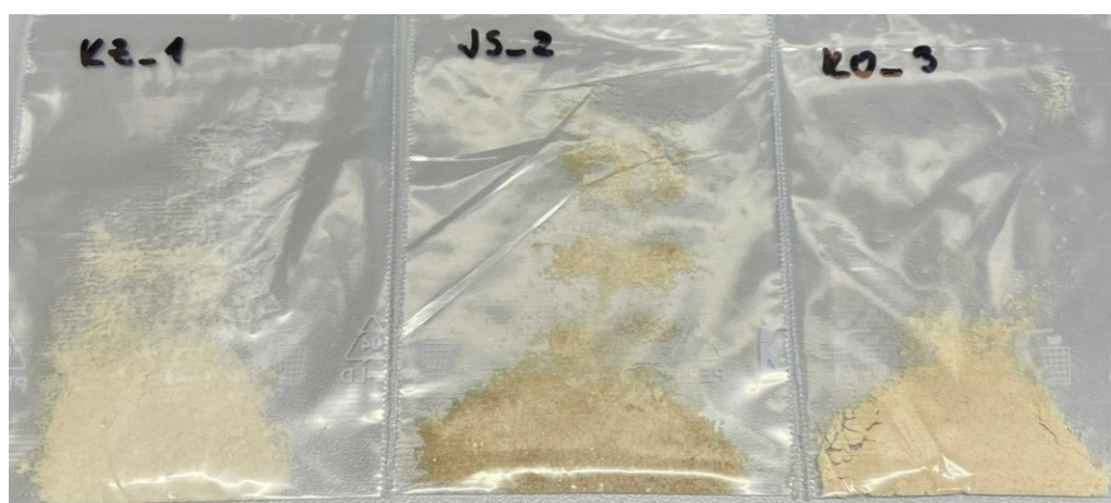
Obrázek 11 Připravené kolagenní hydrolyzáty, KZ_1 = KH z kuřecích žaludků, JS_2 = KH z jeleních šlach, KO_3 = KH z kapřího odpadu
