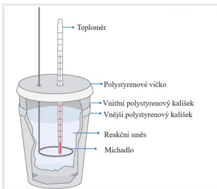
Obrázek 2. Schéma coffee cup kalorimetru (upraveno dle 23 )
