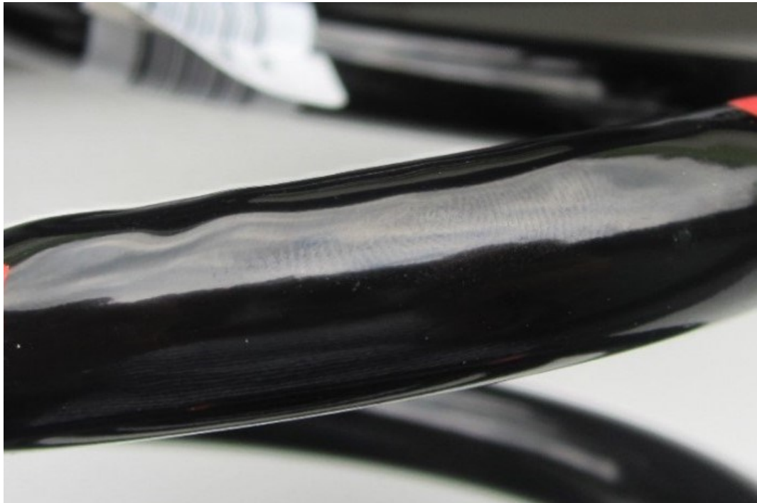
Obrázek 37 – Nerovnosti na povrchu dílu
