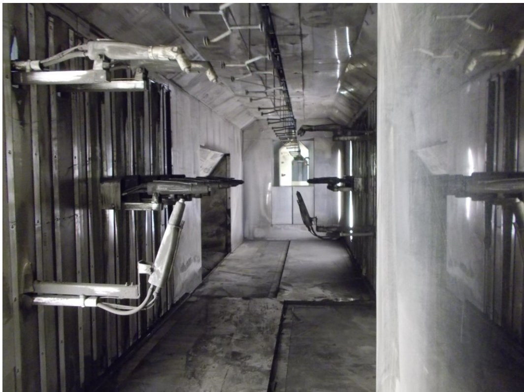
Obrázek 11 – Práškovací kabina zevnitř
