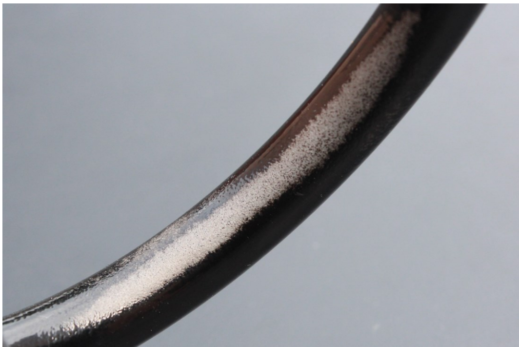
Obrázek 26, 27 – Nedostříknutý lak na dílu
