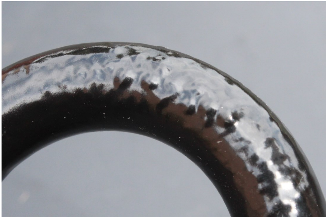
Obrázek 33, 34 – Puchýře na povrchu dílu
