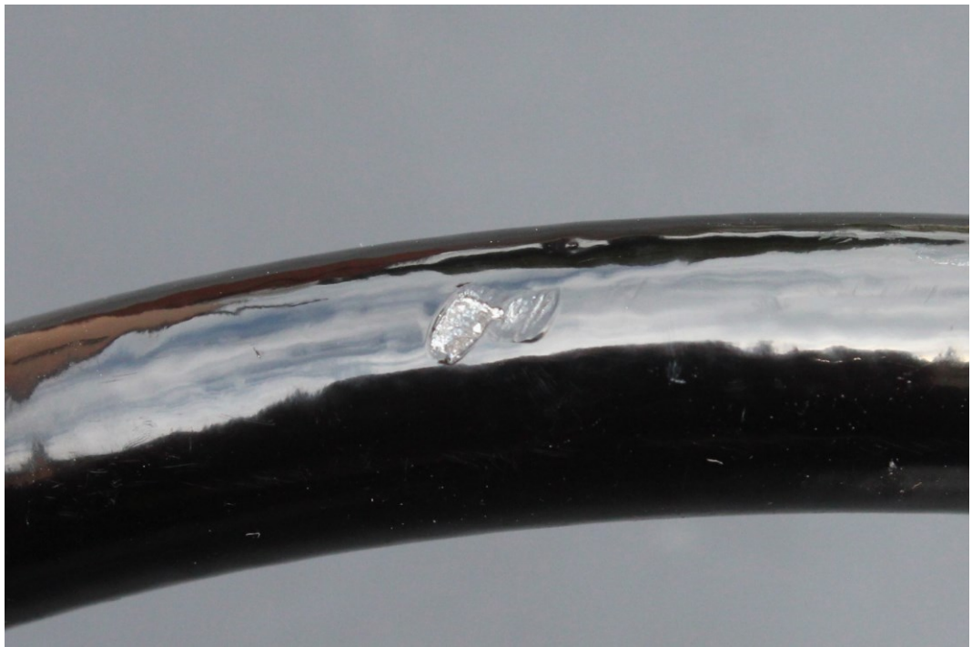
Obrázek 22, 23 – Mechanické poškození laku po vypálení
