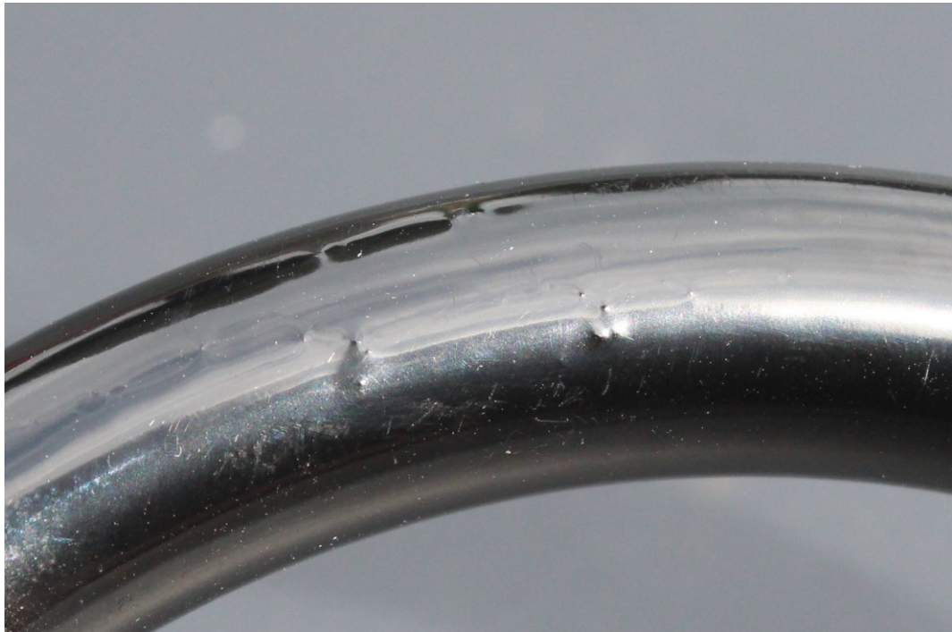
Obrázek 28 – Nečistoty v laku
