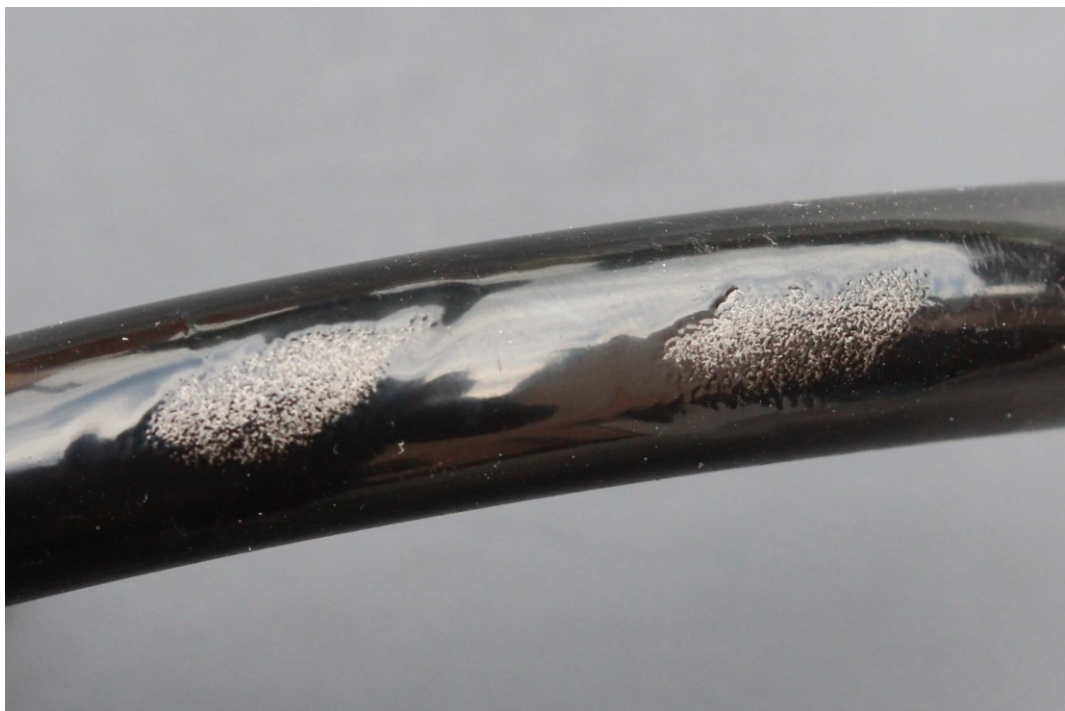
Obrázek 24, 25 – Mechanické poškození laku před vypálením
