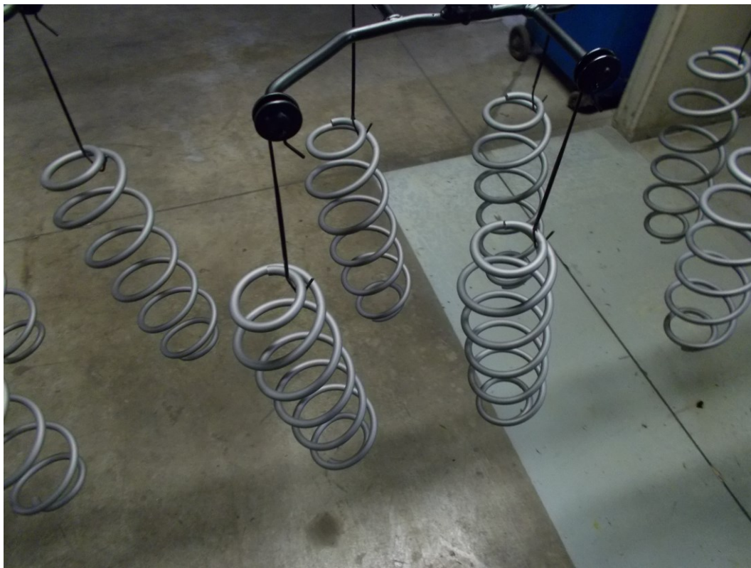
Obrázek 8 – Díly po operaci fosfátování
