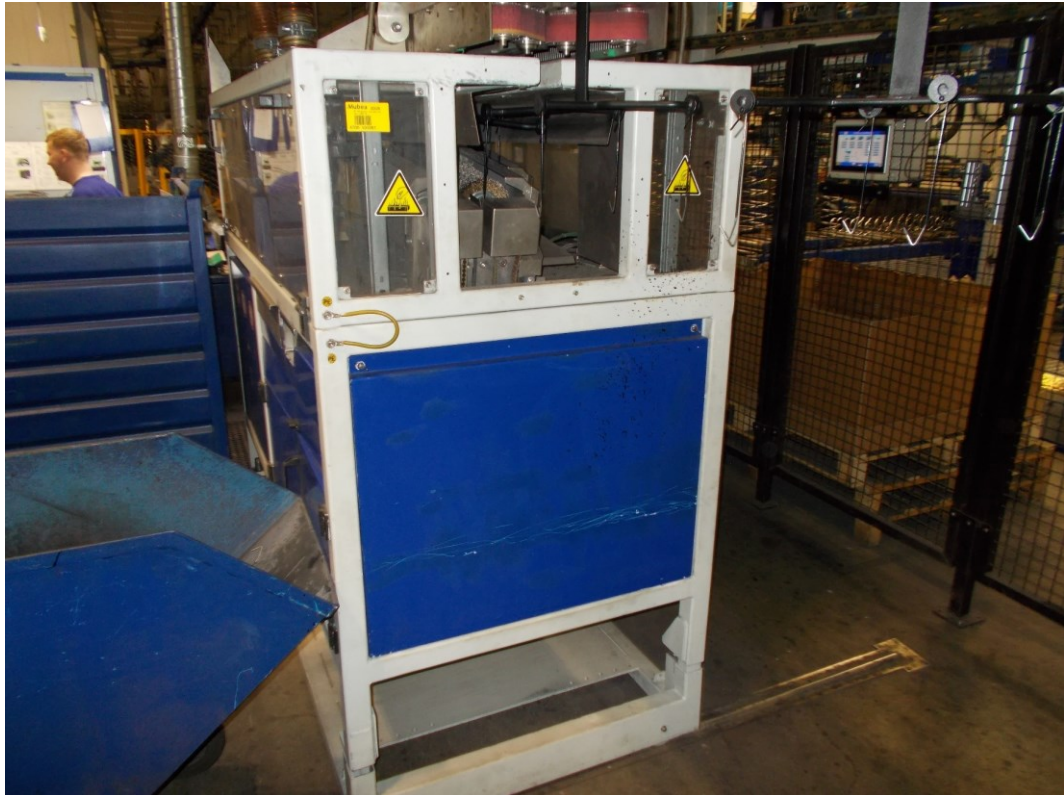
Obrázek 14 – Čištění a opalování háčků
