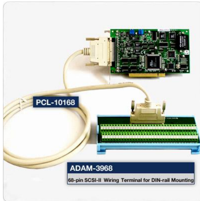
Obr. 40 Karta propojená kabelem se svorkovnicí
