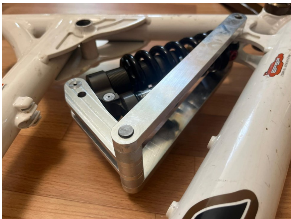
Obr. 38 spojení vzpřímených mechanismů a vahadla volného pivotu
