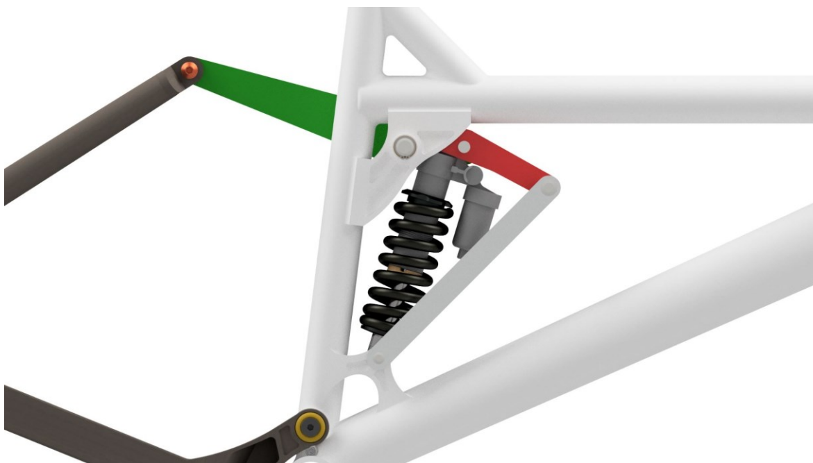
Obr. 41 Tlumící systém v klidové poloze
