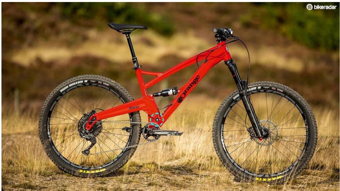
Obr. 5 Jednočepový systém odpružení [8]
