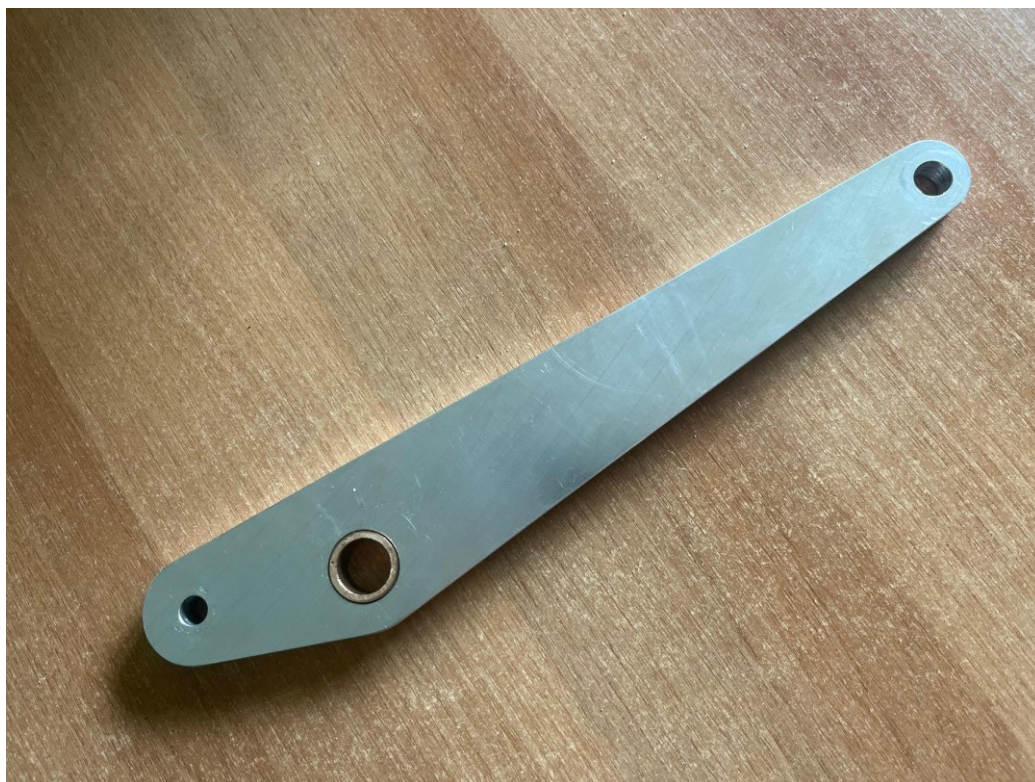
Obr. 33 Vahadlo zadní stavby s nalisovaným ložiskem
