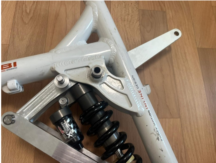
Obr. 39 systém s přidáním vahadlem
