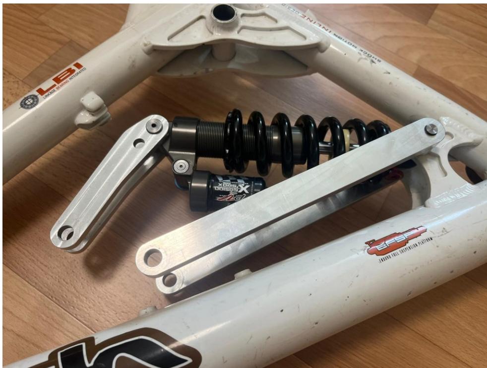
Obr. 37 Rám s tlumičem, vzpřímenými částmi a vahadly horního pivotu
