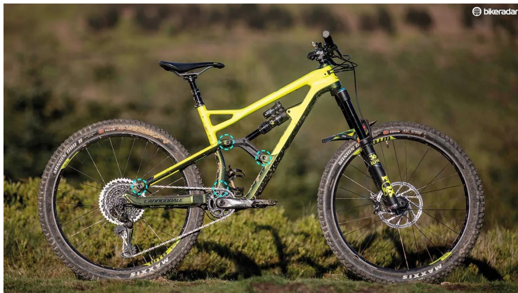
Obr. 6 Jednočep poháněný táhlem [8]
