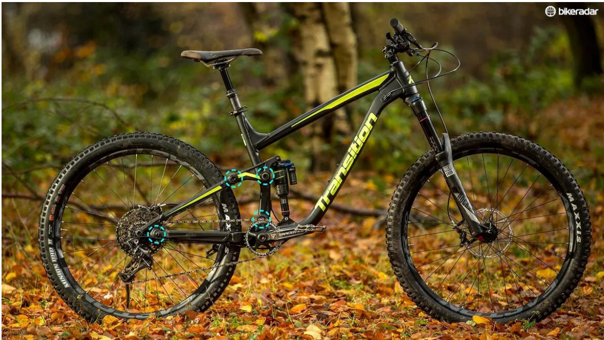
Obr. 8 Čtyřčepový systém zadního odpružení [8]
