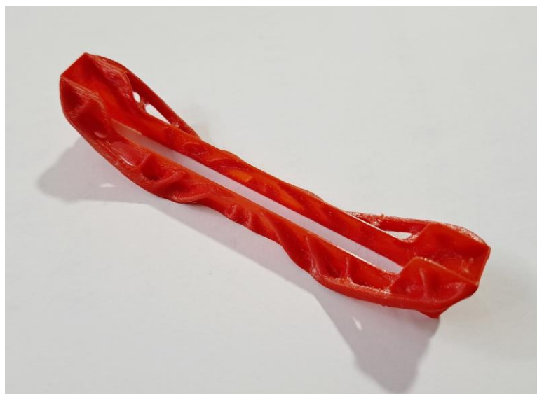
Obrázek 39: Vytištěný přípravek na měření technologií FFF
