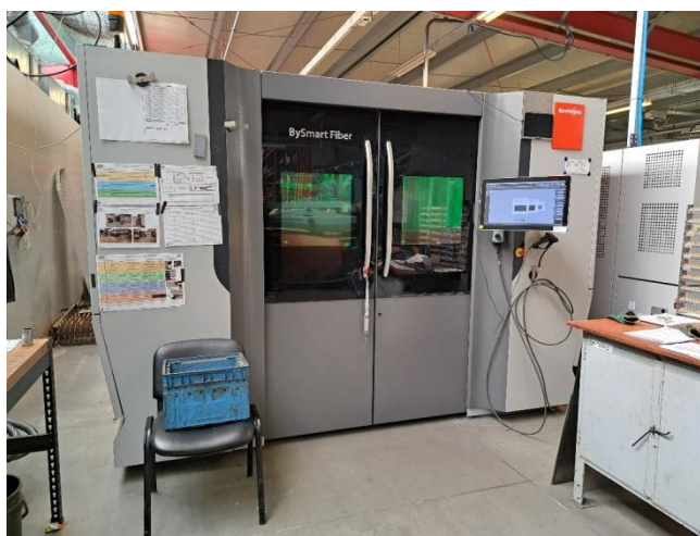
Obrázek 33: Přední část laseru BySmart Fiber 3015 8 kW
