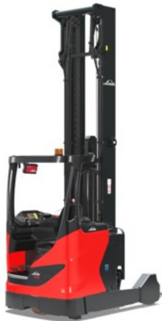
Obrázek 12 Vysokozdvížený vozík retrak (Nové vozíky, c2024)
