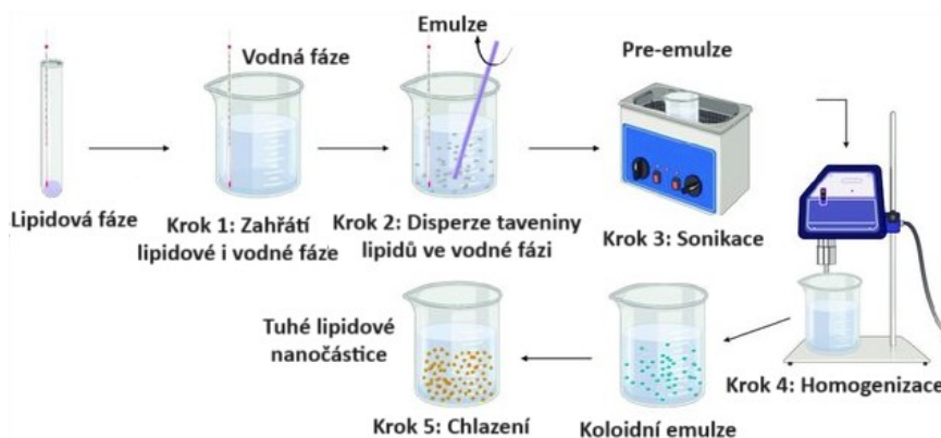
Obrázek 8 Příprava SLN metodou vysokotlaké homogenizace za horka upraveno podle [23]
