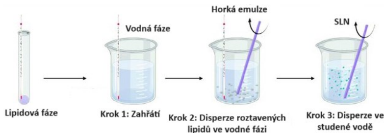
Obrázek 10 Příprava LNP metodou mikroemulze upraveno podle [23]
