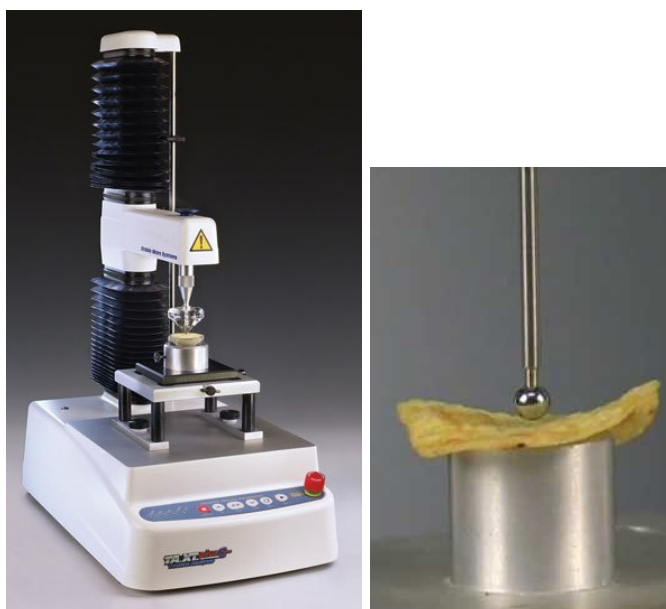
Obrázek 8 Texturometr TA-XT (vlevo), Kuličková sonda (vpravo)
