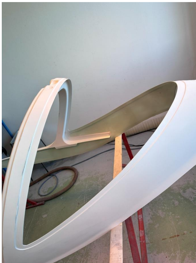
Obrázek 15 Sklopný díl kabiny (zdroj: vlastní)
