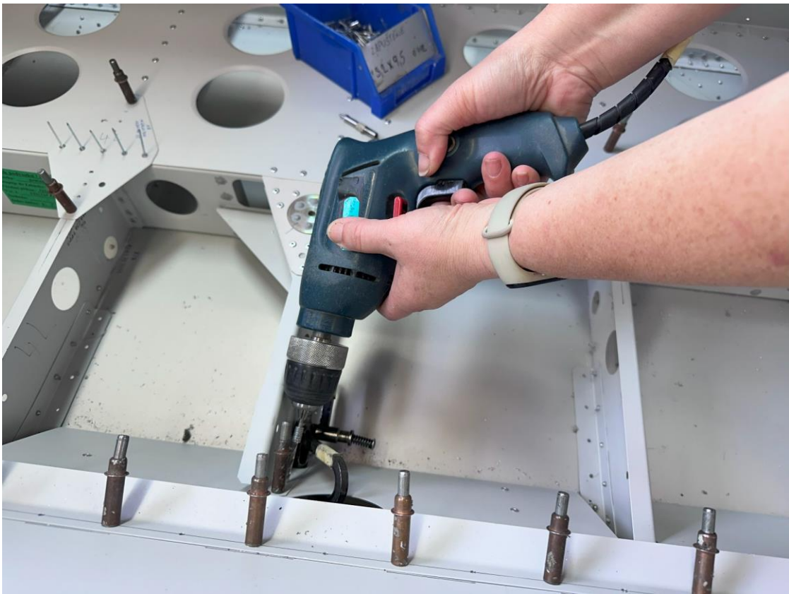
Obrázek 12 Vrtání při montáži trupu letadla (zdroj: vlastní)
