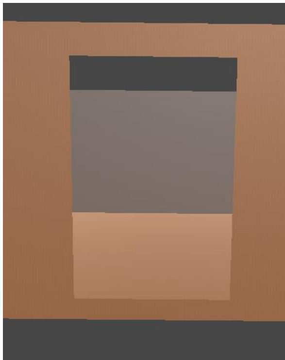
Obrázok 43. Vytvorený otvor pomocou vymazania face-u – tváre
